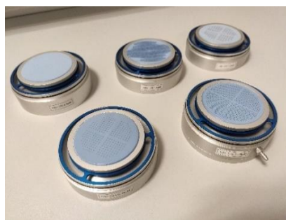
Figura 4. Filtros de las 5 etapas del MOUDI: 2.5, 1.4, 1.0, 0.44, y 0.25 \mu\text{m} (López A.).
