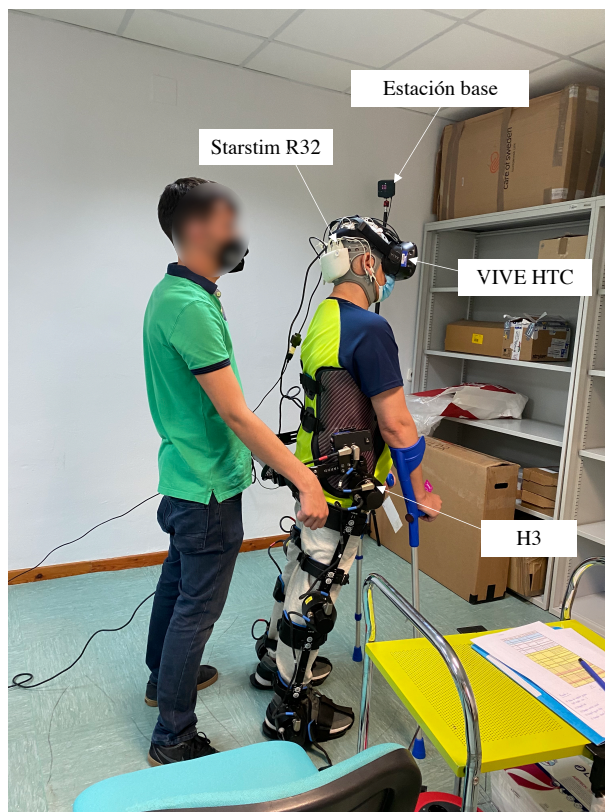
Figura 7.1: Exoesqueleto REX, equipo de electroencefalografía Starstim R32 y equipo de realidad virtual.
