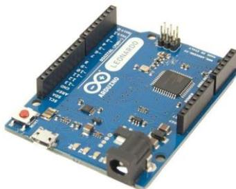
*Figura 1. Placa Arduino Leonardo utilizada en el proyecto.*
