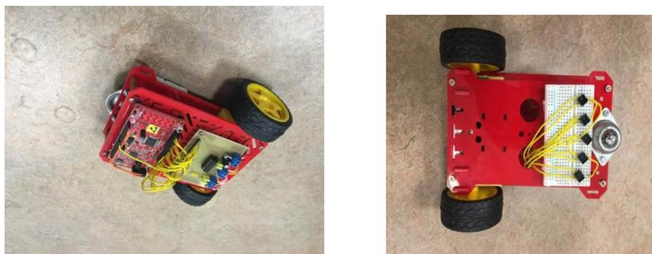
*Figura 1. Vista superior e inferior de robot seguidor de líneas*
