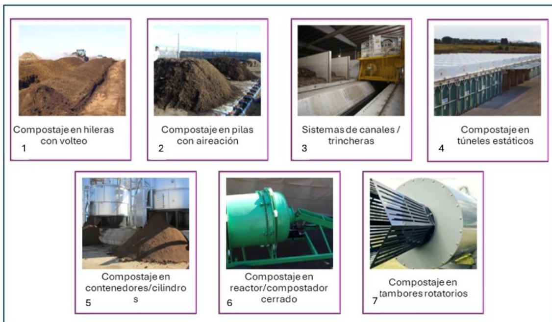
Figura 2 Diversas tecnologías aplicadas a procesos de compostaje.
