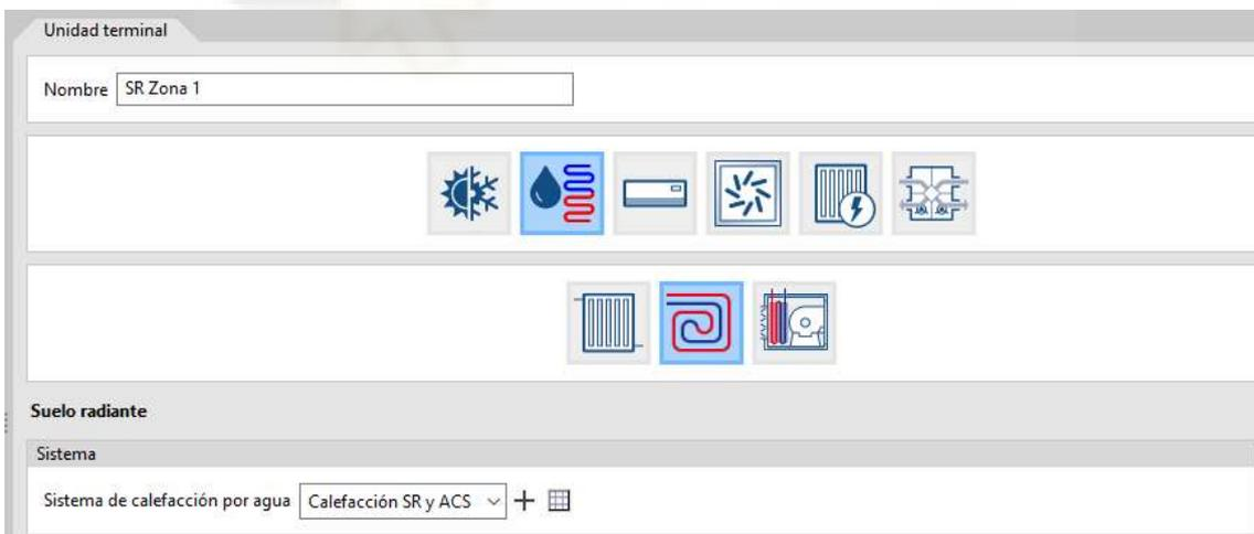
Ilustración 69: Introducción de Unidad terminal de Suelo Radiante en cada Zona. CYPETHERM HE Plus
