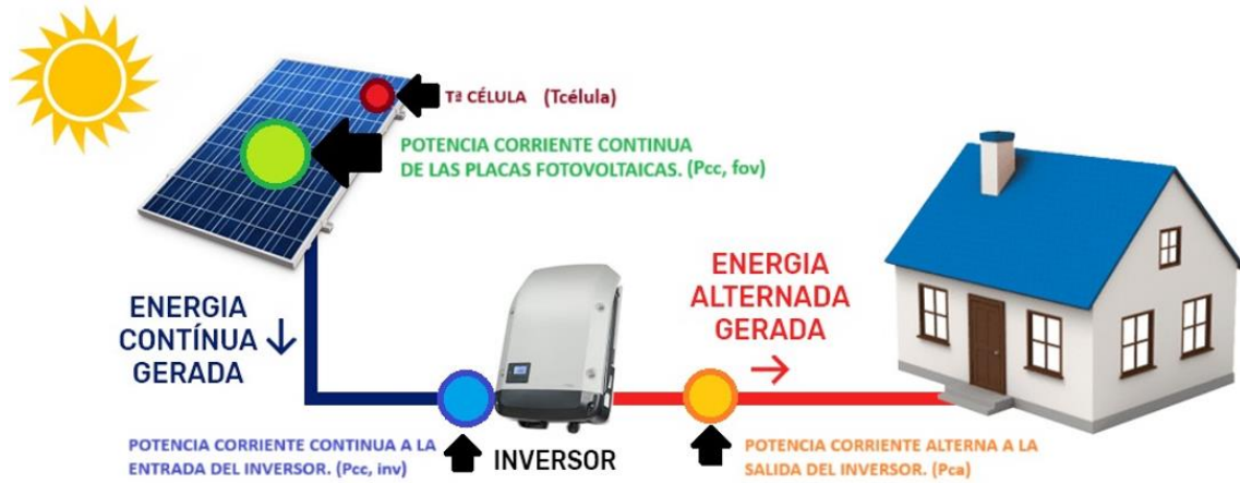
Ilustración 100: Esquema Instalación y datos en cada punto
