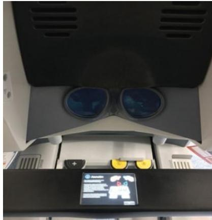
*Figura 2. Visor 3D de la consola maestra <sup>2</sup>*
