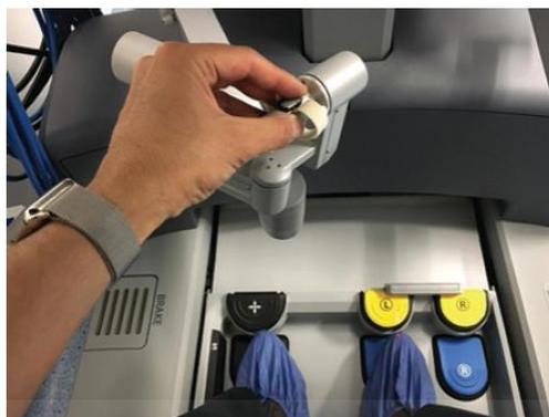
*Figura 5. Manipulador y pedales <sup>2</sup>*
