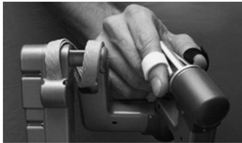
*Figura 4. Manipulador o mango instrumental del sistema Da Vinci <sup>8</sup>*
