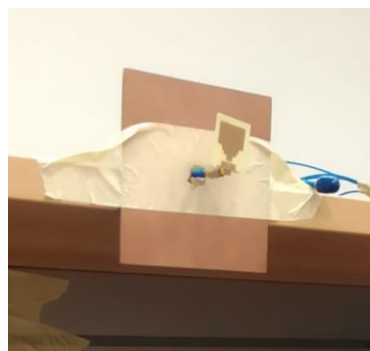
Figura 5.18 Montaje de una antena UWB para el experimento de mediciones de 0 a 100 cm.
