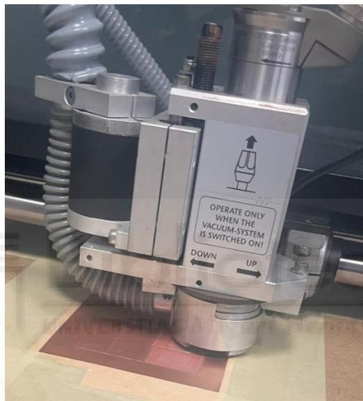
*ILUSTRACIÓN 7. FABRICACIÓN DEL RESONADOR MICROSTRIP DE 0.8 MM DE ANCHO, 21 MM DE LARGO Y UNAS DIMENSIONES DE 46X60 MM MEDIANTE LA FRESADORA LPKF PROTOMAT 93S*
