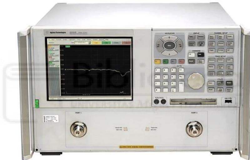
ILUSTRACIÓN 16. ANALIZADOR VECTORIAL DE REDES EMPLEADO E8363B KEYSIGHT
