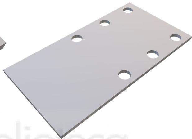
ILUSTRACIÓN 12. RENDERIZADO EN 3D DE LA PIEZA DEL SUSTRATO BAJO ENSAYO MODELADO EN FREECAD PARA SU FABRICACIÓN
