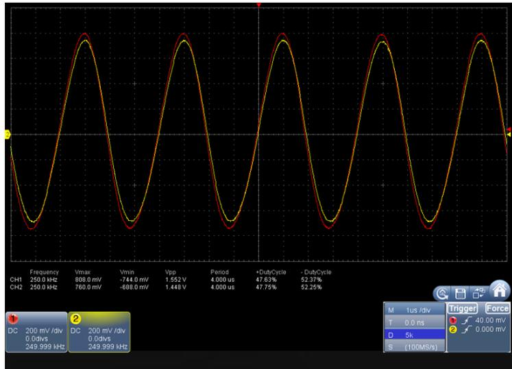
Figura 113. Voltajes inducidos medidos sobre la salida de ambas espiras secundarias
