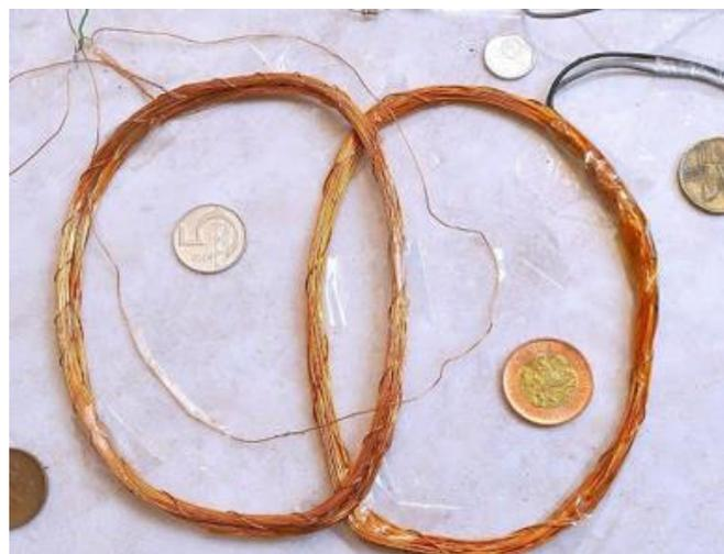
*Figura 16. Bobinas en forma de doble D parcialmente superpuestas*
