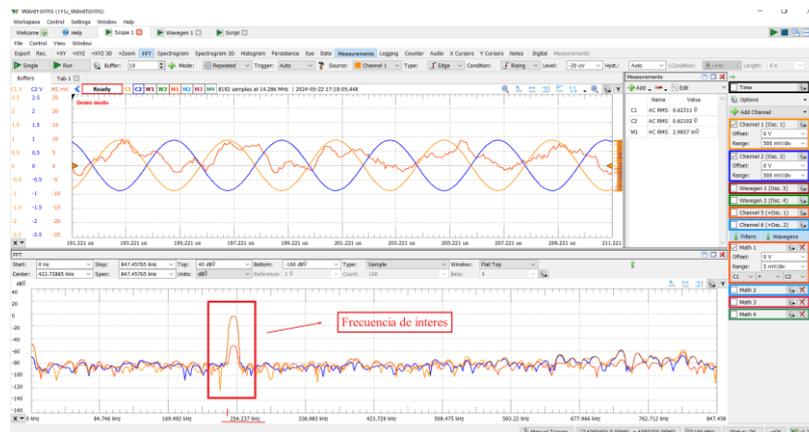
Figura 104. FFT de las señales utilizadas en nuestro sistema
