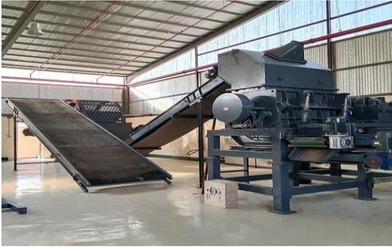
Figura 6. Máquina granuladora [4]
