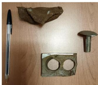
Figura 9. Zoom y comparativa del tamaño de los objetos metálicos causantes de posibles averías
