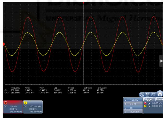
Figura 118. Medidas directas tras el segundo amplificador
