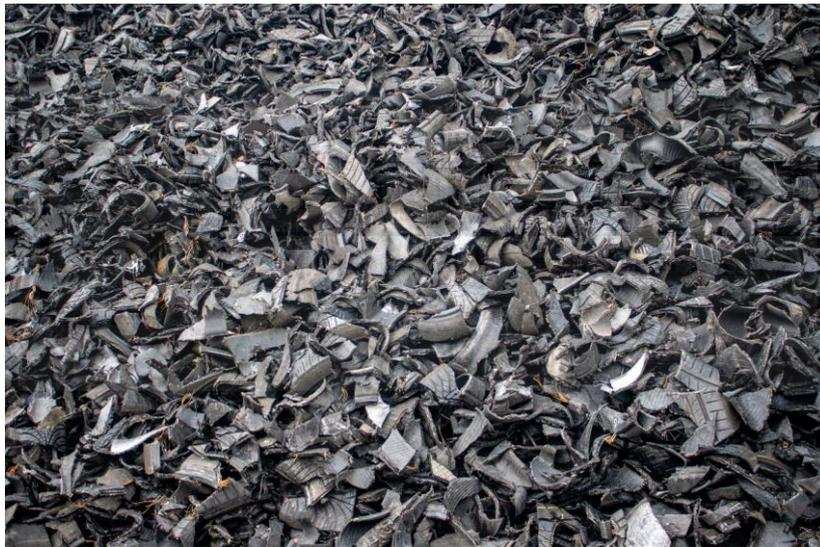
Figura 4. Fragmentos de neumático triturado de 10 cm [3]
