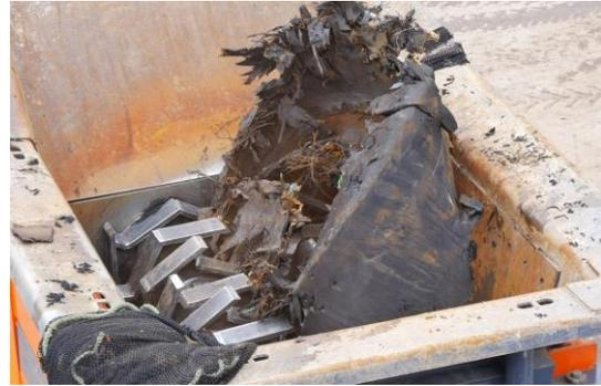
Figura 3. Neumático siendo triturado [3]
