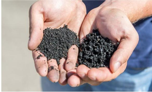
Figura 7. Neumático granulado entre 2 – 4 cm [5]
