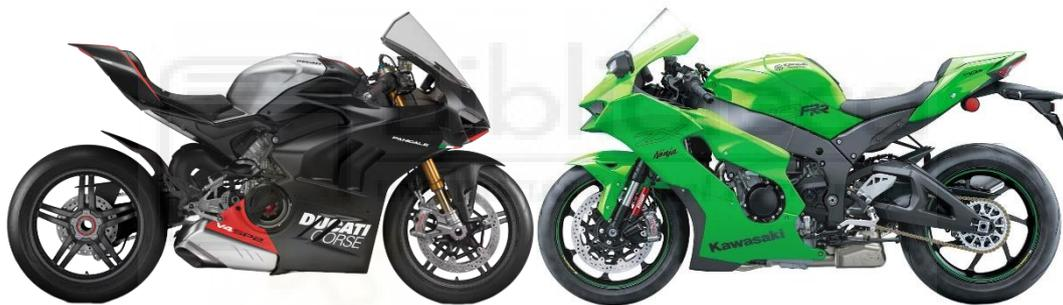
*Ilustración 2 Motocicletas con basculante monobrazo y doble brazo*
