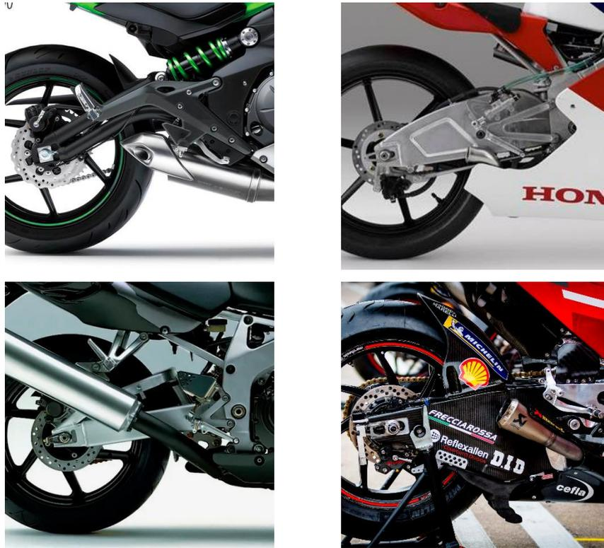
*Ilustración 3 Diferentes tipologías de basculante*
