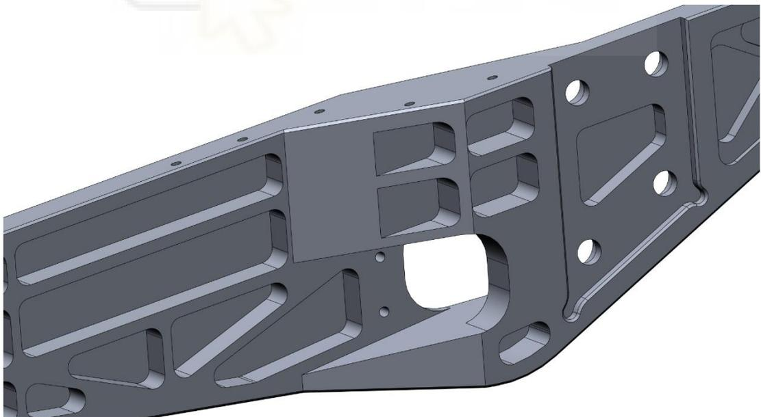
*Ilustración 123 Versión final: detalle vaciados zona de transición brazo izquierdo*
