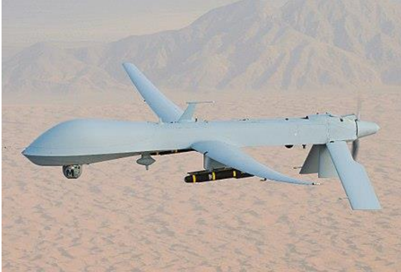
Ilustración 1. General Atomics MQ-1 Predator. “Vehículo aéreo no tripulado (UAV) desarrollado durante los años 90 por la Fuerza aérea estadounidense. UAV de altitud media y gran autonomía”.
