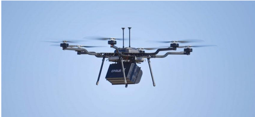
Ilustración 5. “Prueba en vuelo de un sistema de microondas en un dron”. Disponible en: https://www.hispaviacion.es/los-drones-militares-del-futuro-podrian-llevar-sistemas-microondas-para-derribar-a-otros-drones/
