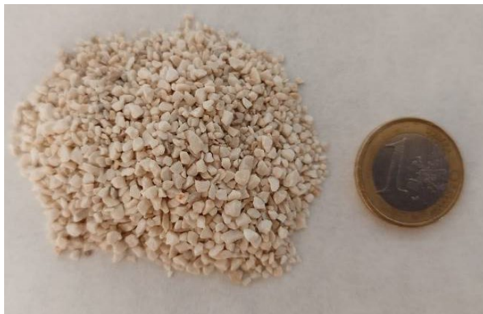
Figura 5. Grava caliza. Fuente: Elaboración propia.
