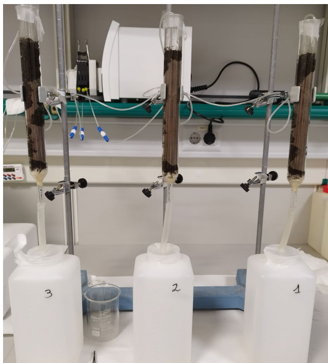
Figura 4. Montaje columnas de lixiviación. Fuente: Elaboración propia.
