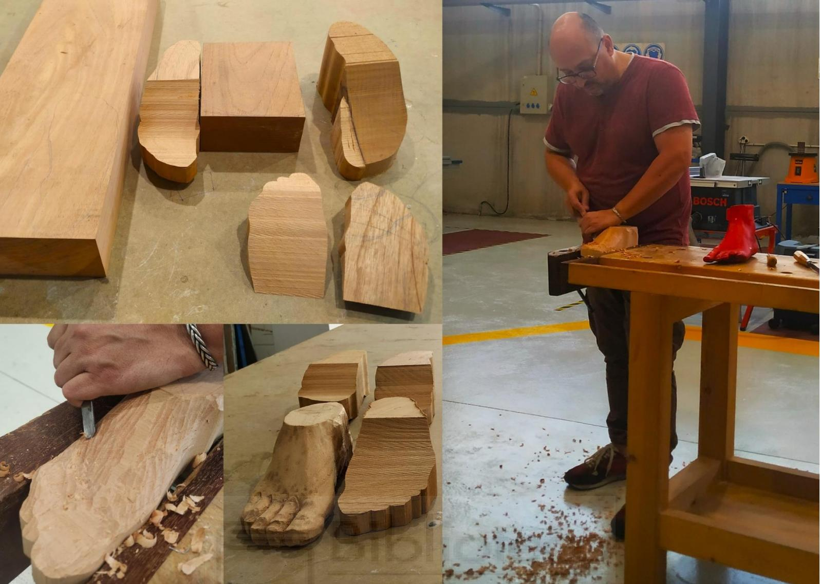
Figura 10. Detalle del tallado manual de las piezas.
