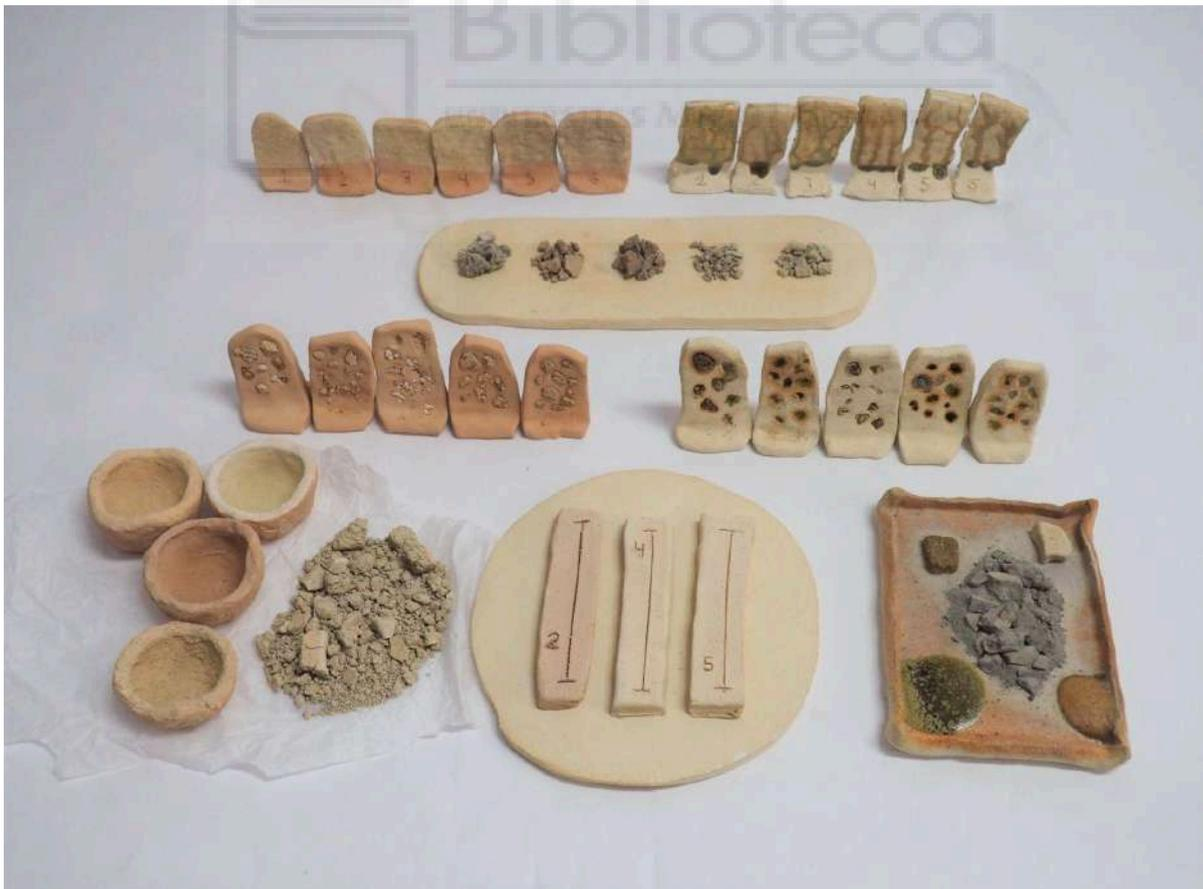
Fig. 11. Resultados de las pruebas con posibles barros y vidriados en alta y baja temperatura.
