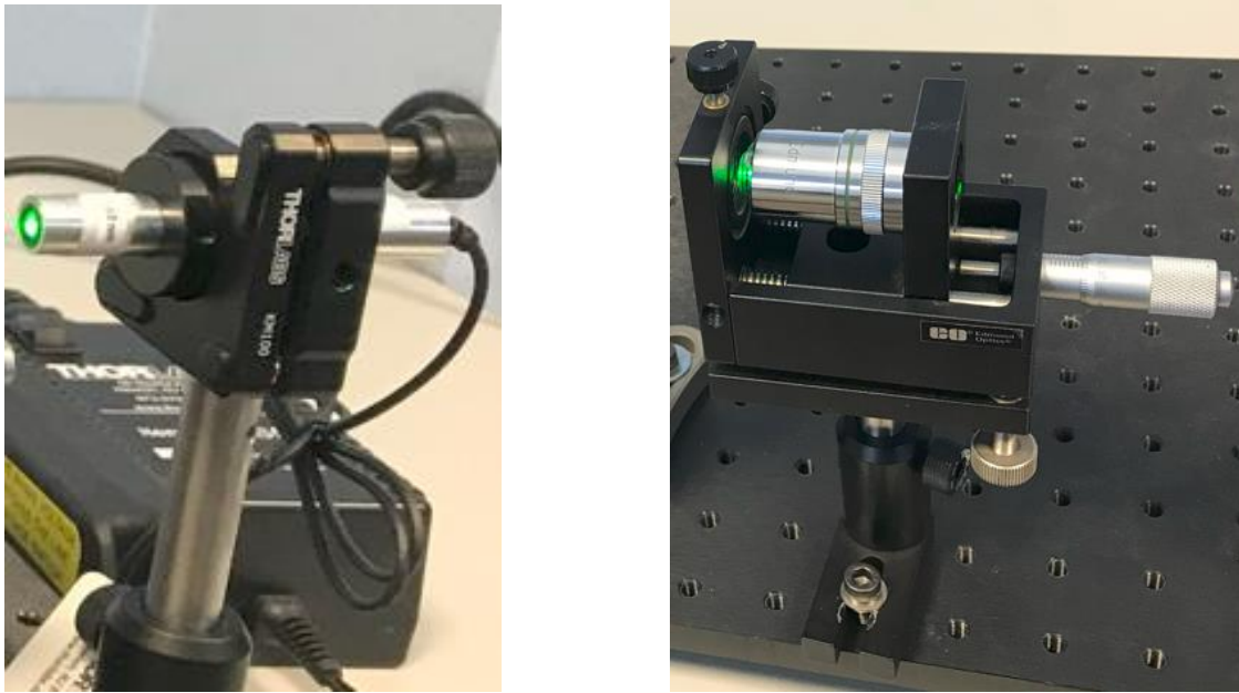
Fig. 4.3. Detalle del láser CPS532 con soporte KM100 y del objetivo de microscopio sobre montura con ajustes micrométricos.
