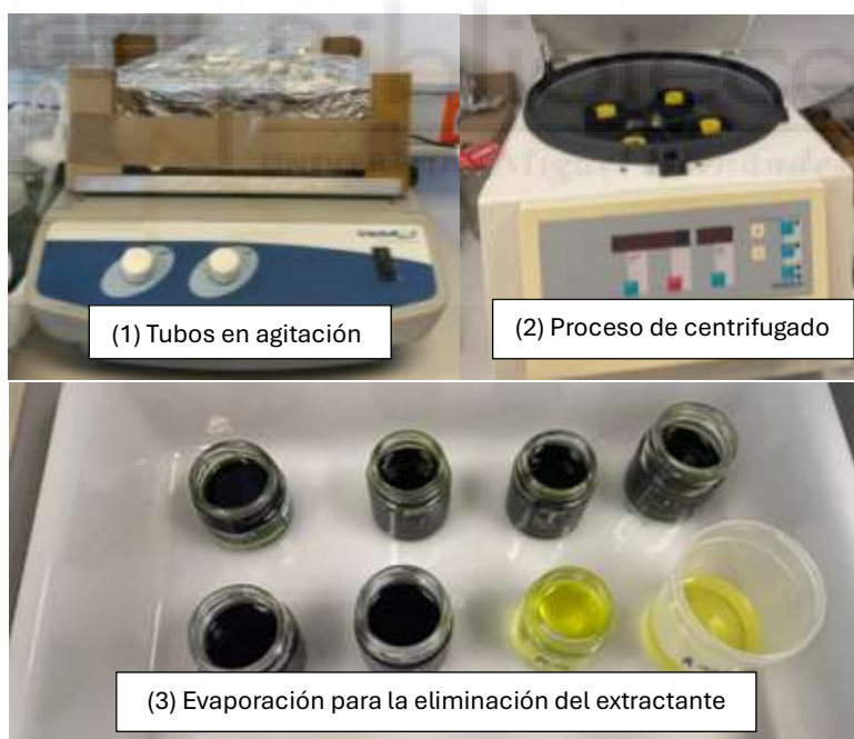
Figura 5. Detalles del proceso de obtención de los extractos vegetales. Tubos en agitación (1); Proceso de centrifugado (2); Evaporación para la eliminación del extractante (3).
