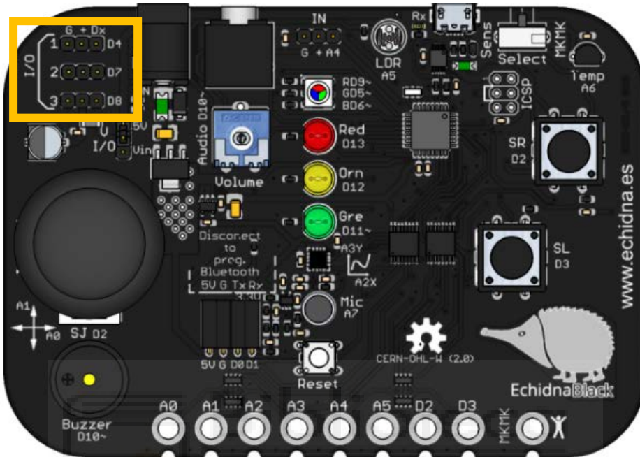
Imagen 10. Conexión a pines entrada-salida placa Echidna (Echidna Educación, 2024)
