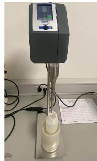
Figura 15: Sonicador Hielscher UP400St, utilizado para romper las células en el proceso de purificación de la proteína.
