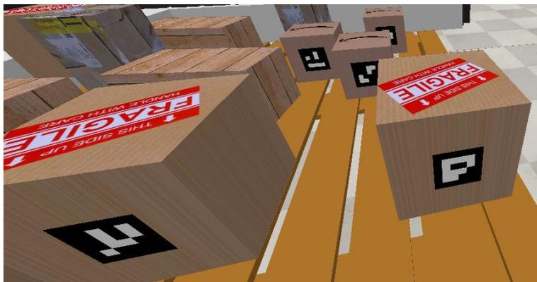
Figura 3.14 Marcadores ArUco en las Cajas (paquetes de la simulación).
