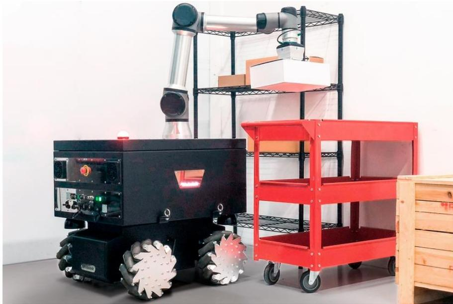
*Figura 2.5 Robot móvil RB-Kairos+, Robotnik Automation S.L.*
