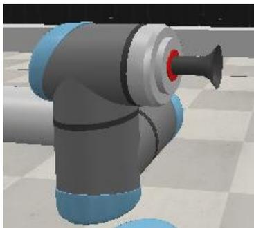
Figura 3.12 Efecto final del brazo robot colaborativo UR10e, ventosa de vacío.
