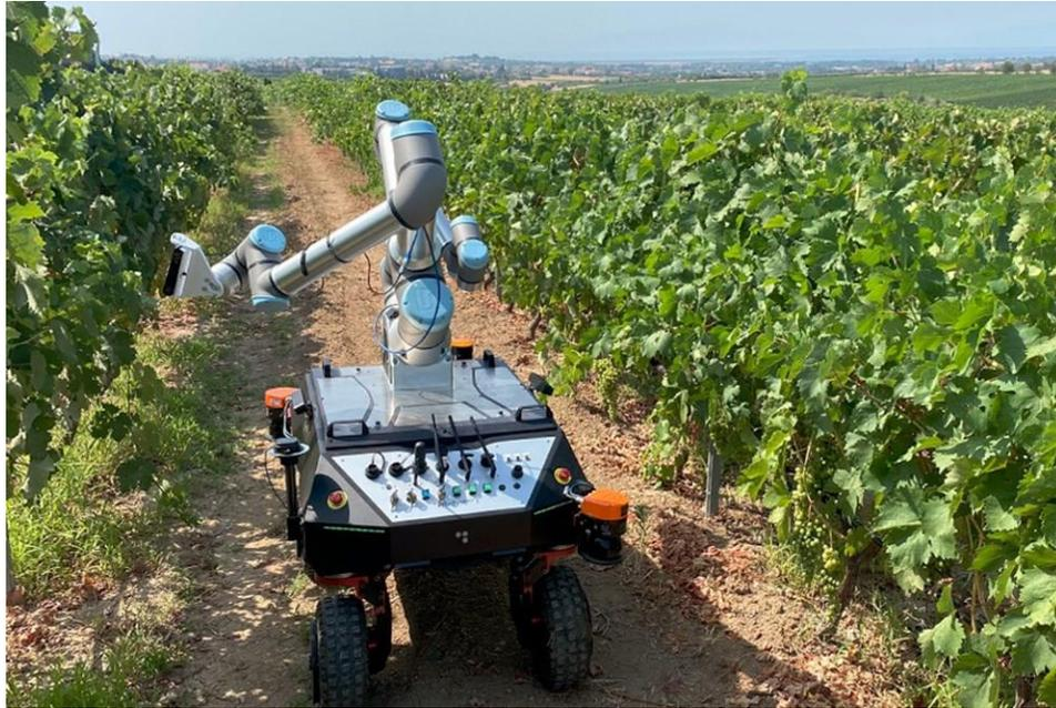
*Figura 2.8 Robot Móvil RB-VOGUI+ DUAL con dos brazos robóticos UR integrados.*
