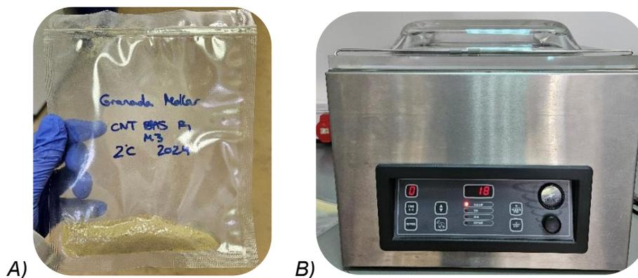
**Figura 8. A)** Bolsa termosellada con una muestra homogénea en polvo de la piel de la granada 'mollar de Elche'. **B)** Termoselladora automática de vacío.
