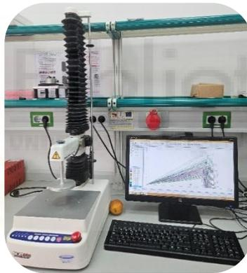
**Figura 9.** Texturómetro TA-XT21<sup>®</sup> empleado en el análisis de la firmeza del fruto.
