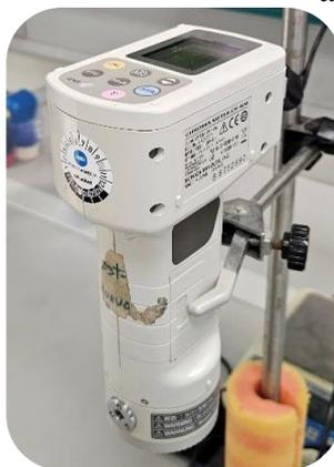
**Figura 10.** Colorímetro (KONICA MINOLTA, CR-400).
