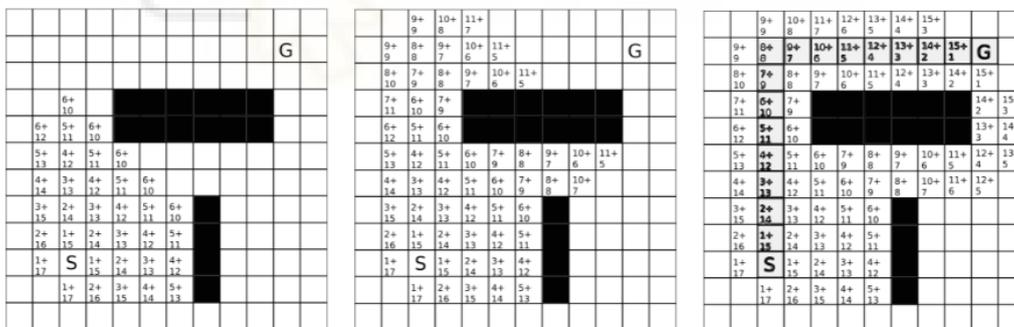
Figura 3-10. Algoritmo de A\* encontrando una ruta más corta de 'S' a 'G' suponiendo que el robot solo puede viajar lateralmente (no diagonalmente) con un costo de uno por celda de cuadrícula más el costo heurístico.
