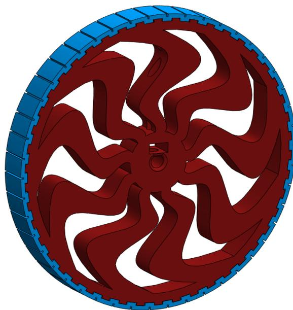
Figura 30. Diseño Rueda PLA-TPU
