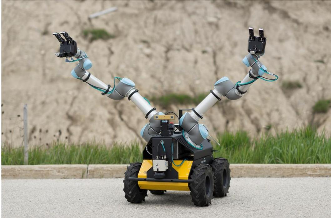
*Figura 28 Robot Husky montado con dos robots manipuladores.*
