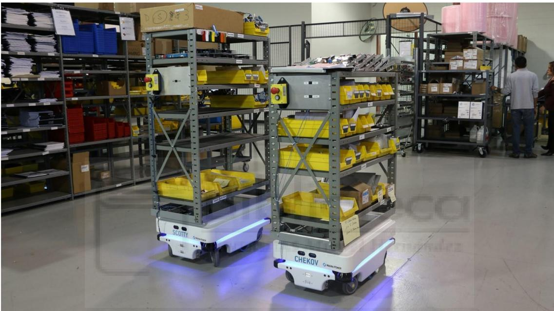
Figura 2 Robot móvil CHEKOV de Magna Power.
