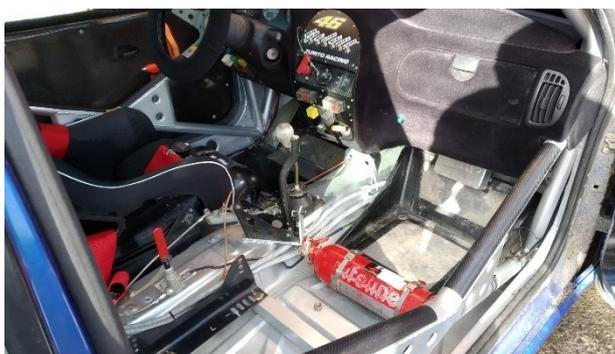
Ilustración 30 Montaje Salpicadero y jaula de seguridad, 2019, Fuente: <https://mercadoracing.com/se-vende-citroen-saxo-vts-grupo-a-homologado-para-rallys-ad-723323>
