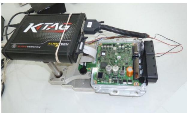
Ilustración 36 Puentado de centralita motor con diagnosis Ktag, 2024 Fuente: <https://kns-electronica.com/ecuremap/>
