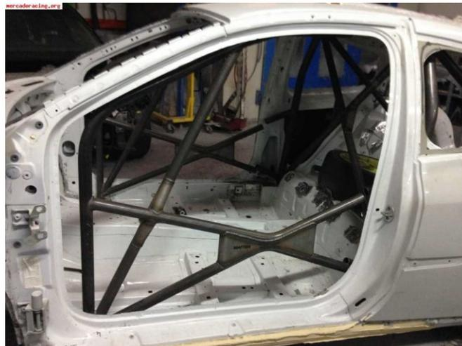
Ilustración 28 Instalación jaula de seguridad, 2016, Fuente: <https://mercadoracing.com/prolecto-clio-r3-ad-663797>
