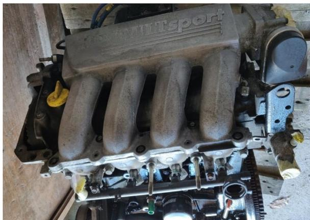
Ilustración 31 Motor Renault Clio Sport sin periféricos, 2018, Fuente: <https://mercadoracing.com/motor-clio-sport-172-y-182-ad-711989>
