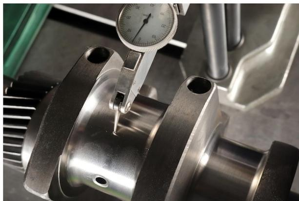
Ilustración 33 Medición de las muñequillas del cigüeñal, 2024, Fuente: [https://www.freepik.es/fotos-premium/master-realiza-medicion-dureza-metales-ciguenal\\_51812743.htm](https://www.freepik.es/fotos-premium/master-realiza-medicion-dureza-metales-ciguenal_51812743.htm)
