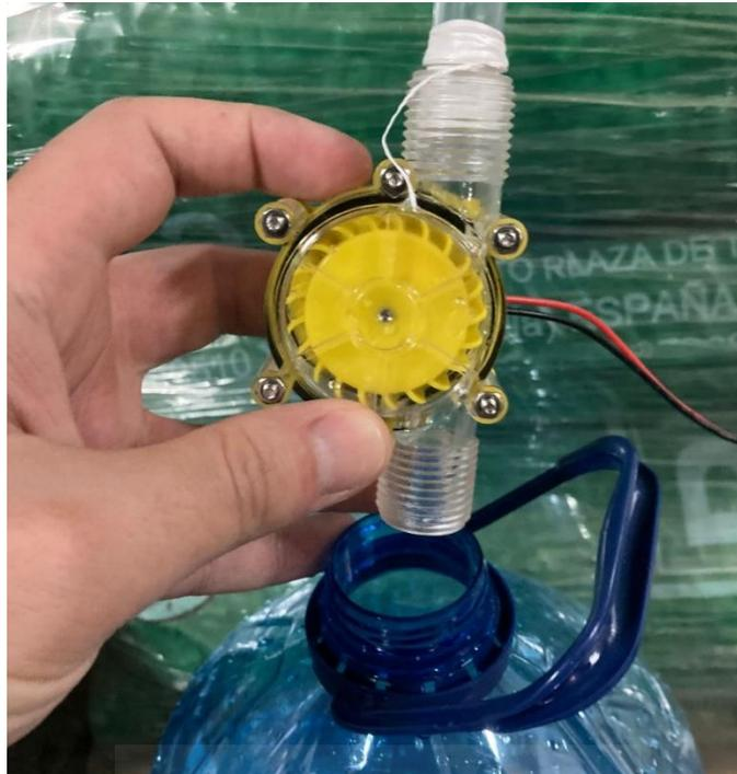
Figura 10. Turbina de generación hidroeléctrica.
