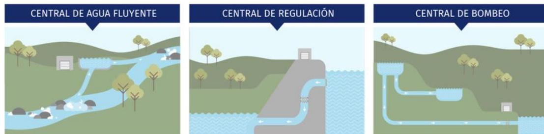
Figura 7. Tipos principales de generación hidroeléctrica.
