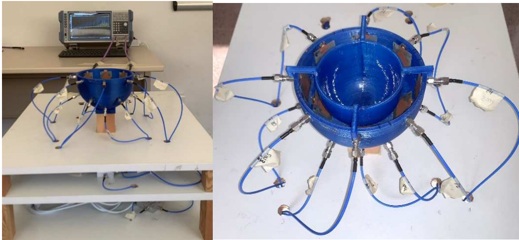
Figura 1: Sistema experimental completo a) sistema físico más VNA, b) antenas montadas en el contenedor y molde interior.
