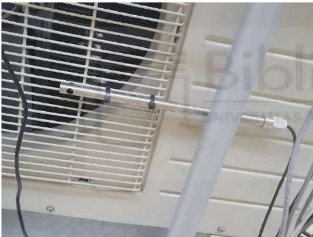
Figura 3.23: Sonda del anemómetro colocada a la salida del ventilador
