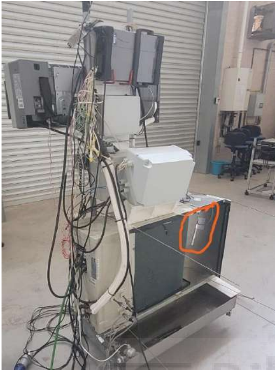
Figura 3.21: Termohigrómetro colocado en el lugar de la parrilla de atomización
