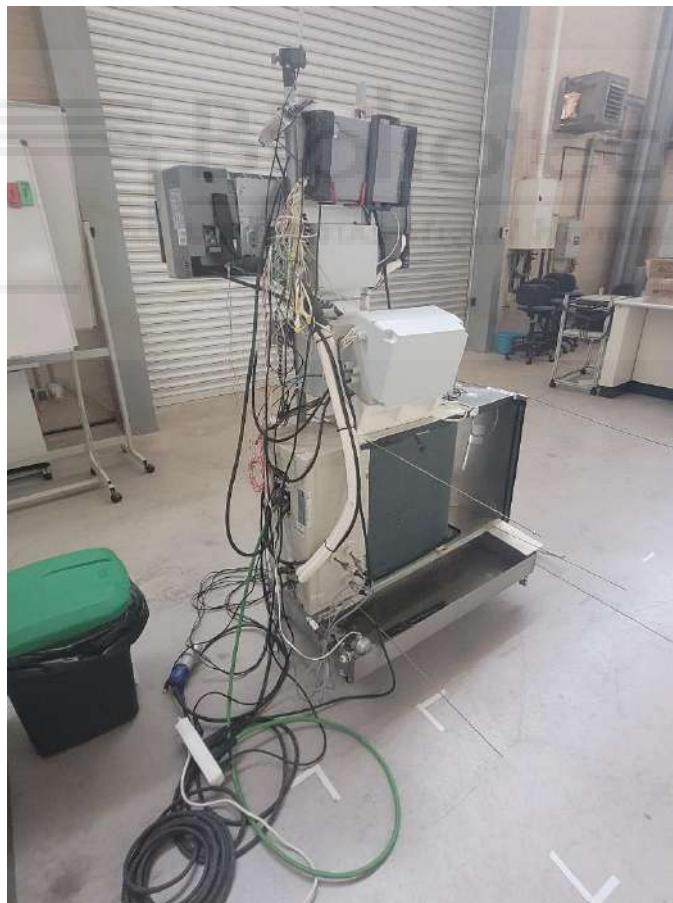
Figura 4.1: Instalación del equipo de clima. Unidad de adquisición de datos en la parte superior de la misma
