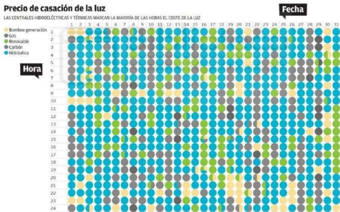
Figura 1.6: Tecnologías que han marcado el precio de la luz en julio de 2021 [11].
