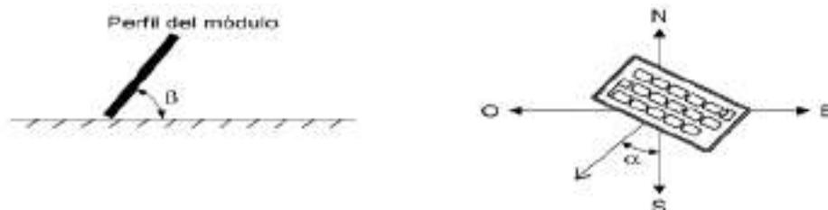
Ilustración 31. Inclinación y azimut.
