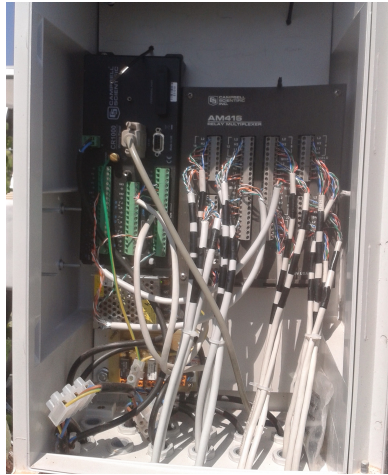
Figura 19: Sistema de conexión del Datalogger
