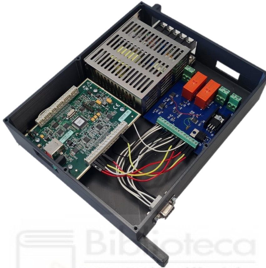
Figura 39. Sistema de carga dinámica integrado en el mecanizado
