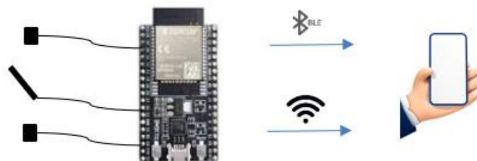
Ilustración 17. Envío de datos desde el ESP32 haciendo uso de diferentes tecnologías
