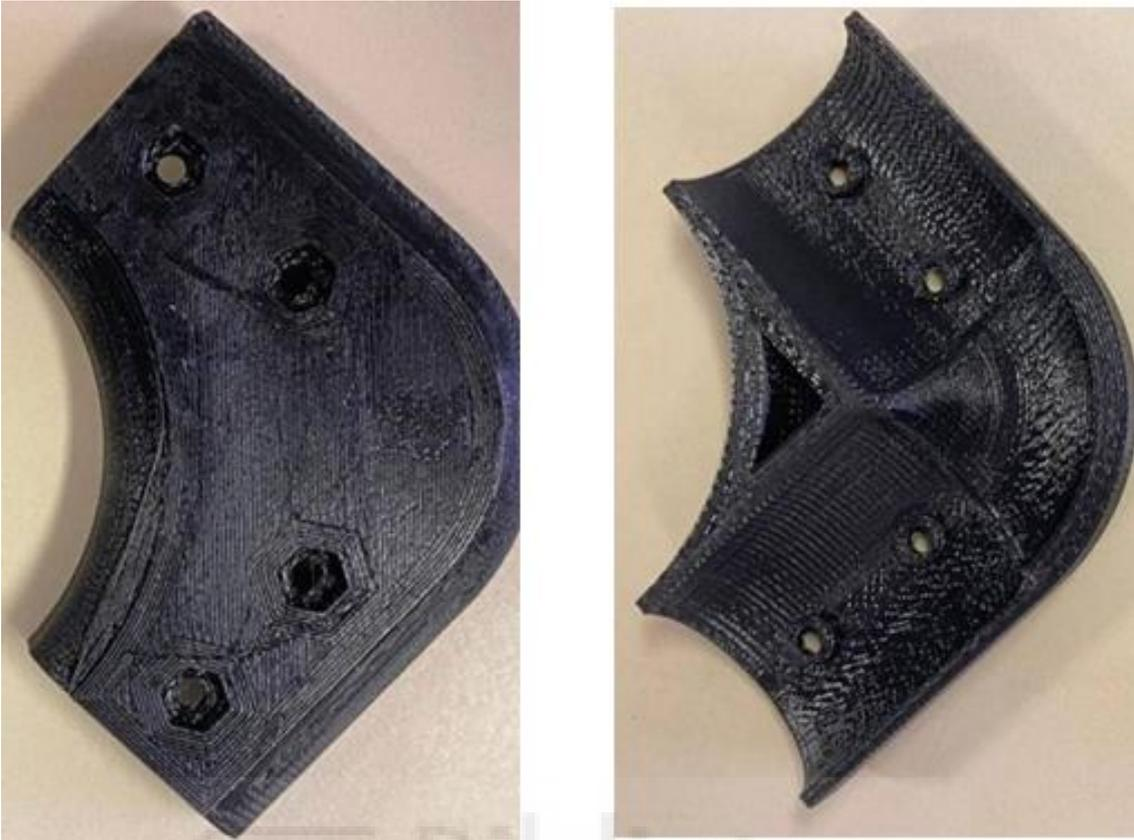
Imagen 52: Foto en detalle de ambas caras de las mitades del codo definitivo que se instalará en el “Dátil 21” (Tercera generación)
