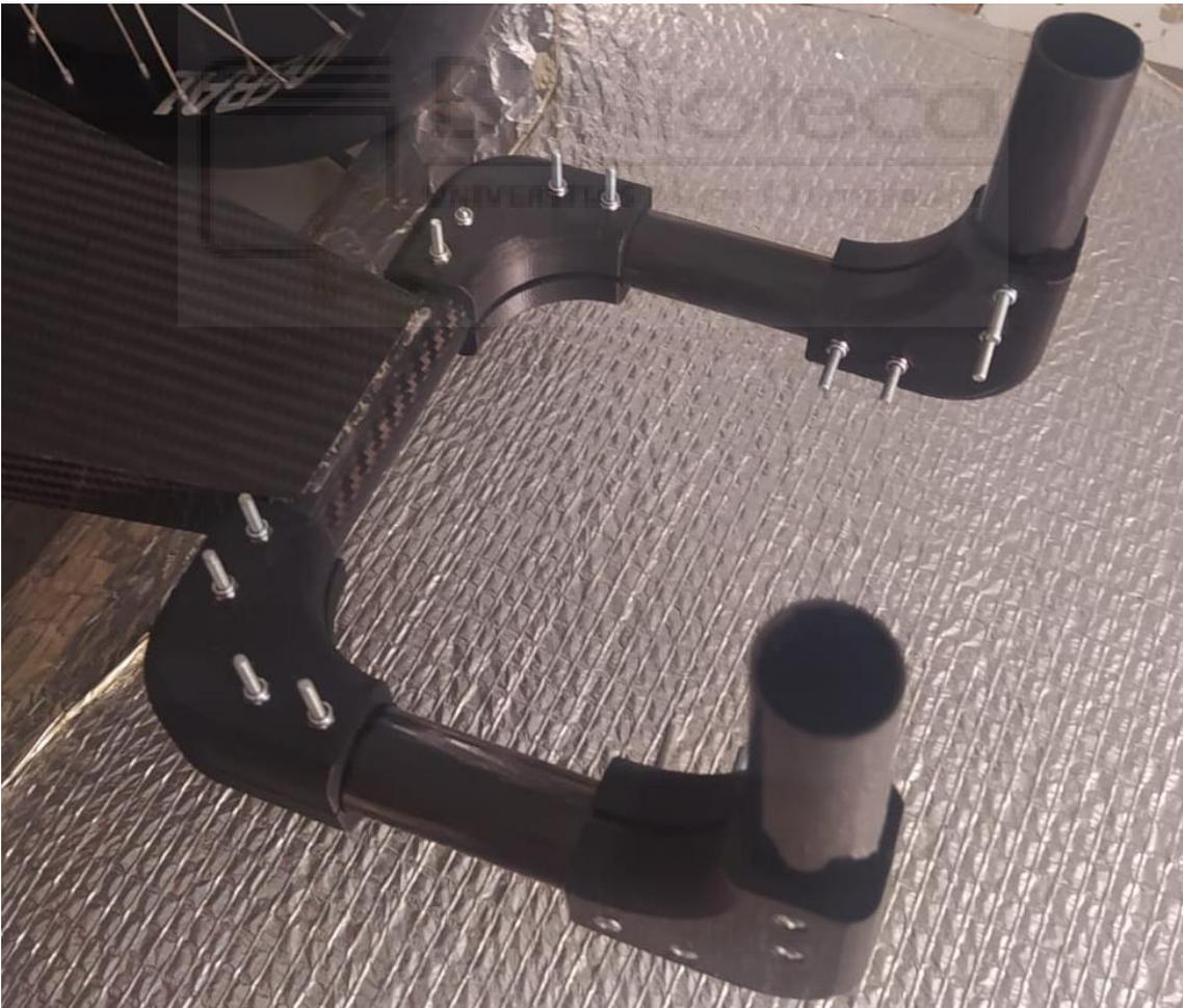
Imagen 56: Foto detalle del manillar completo instalado, a falta de cortar el sobrante de los tornillos
