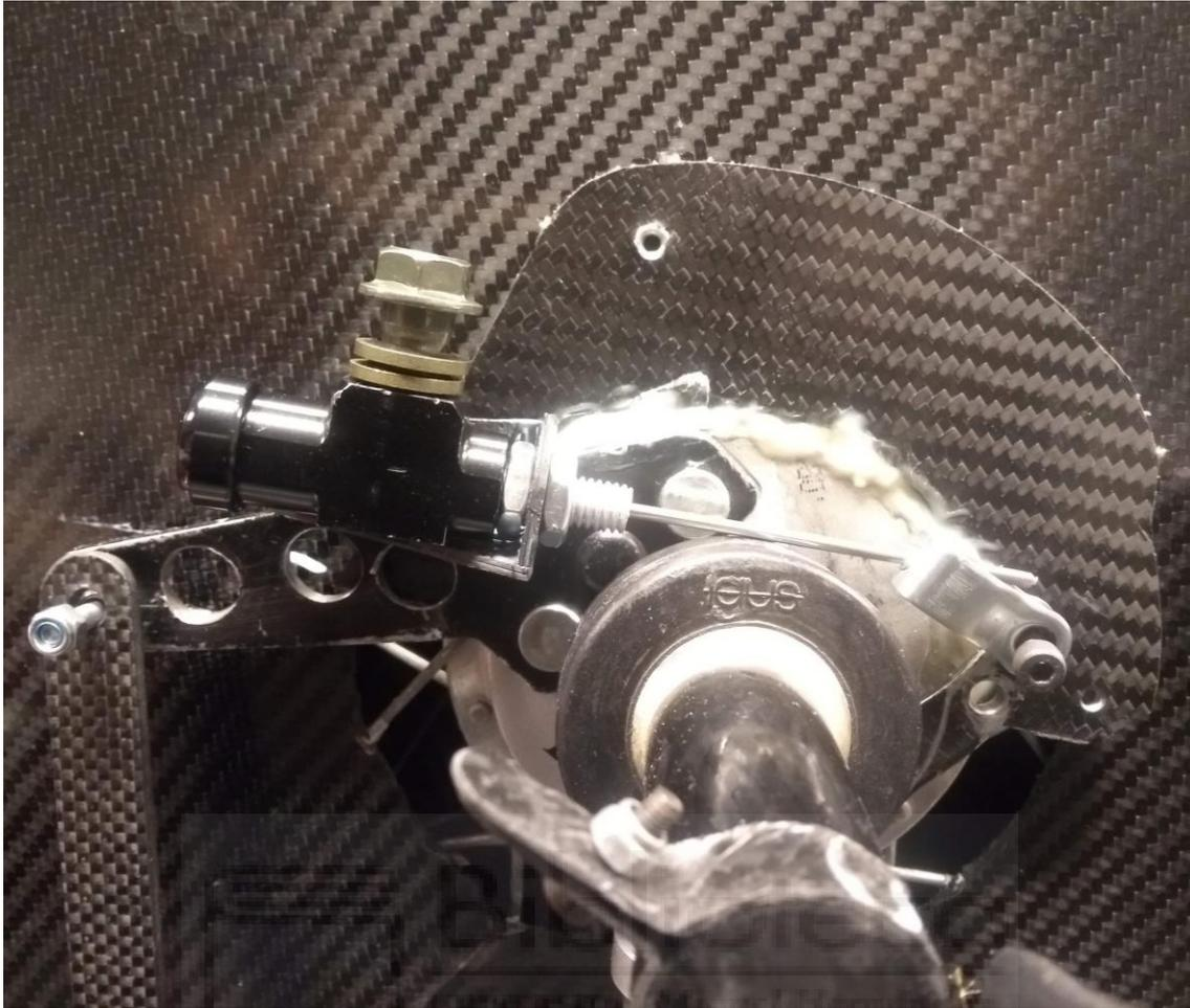
Imagen 67: Foto detalle de la pieza terminada, ya instalada en el sistema de frenos. (Nótese que se recortó la rosca y el vástago del cilindro para aligerarlo lo máximo posible).
