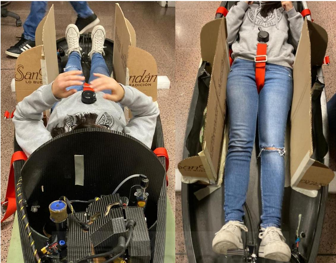
Imagen 37: Maquetas en escala 1:1 de los pasos de rueda, instaladas en el coche con la piloto en posición de carrera.
