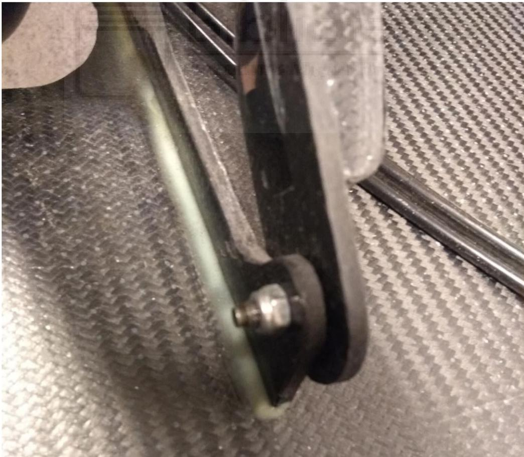
Imagen 19: Detalle de la parte de la cercha que se deforma lateralmente
