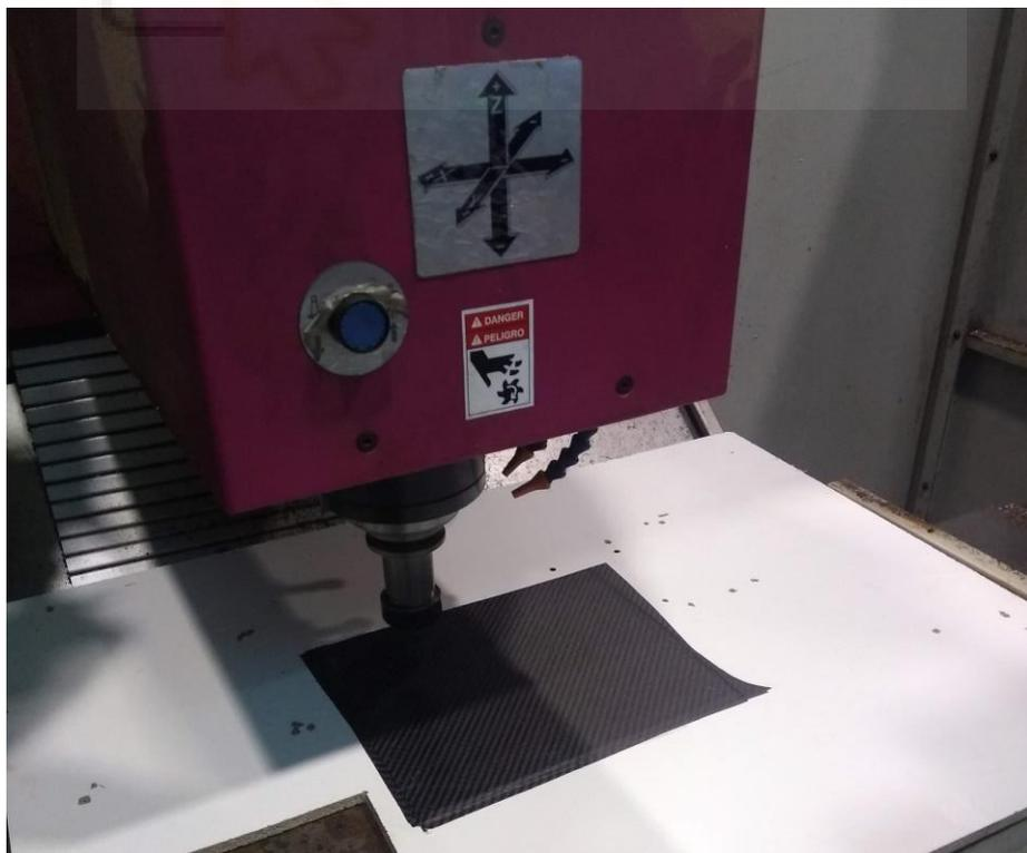
Imagen 63: La fresadora CNC mecanizando la placa de carbono
