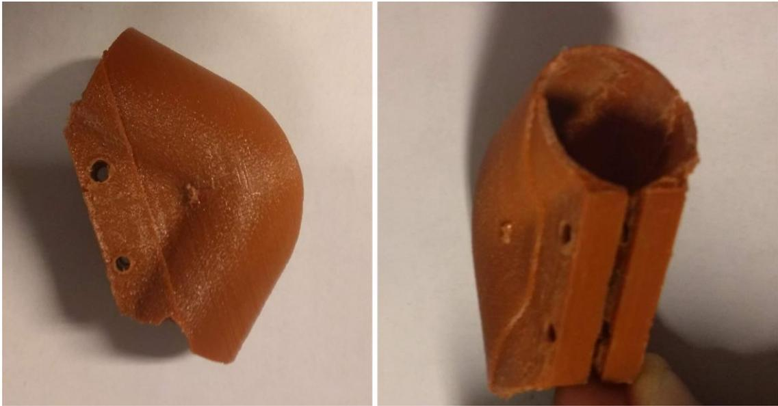
Imagen 48: Foto de la primera generación de codos (modelo de 1 sola pieza)
