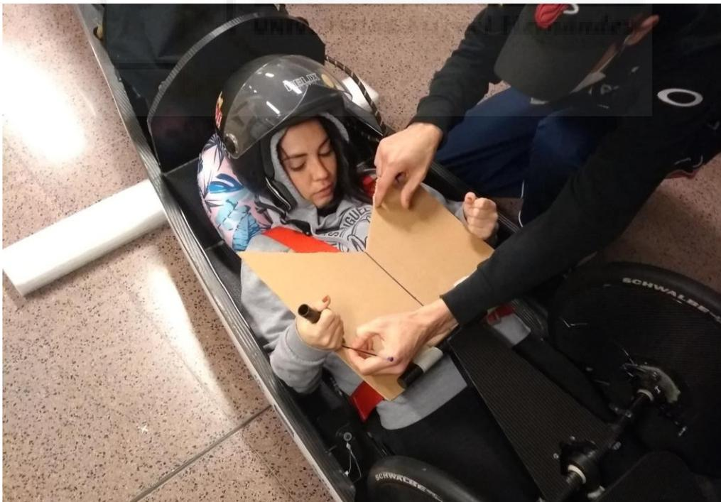
Imagen 15: Prueba para encontrar la posición más cómoda del manillar, utilizando una plantilla de cartón
