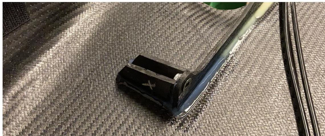
Imagen 32: Detalle del lado derecho del vehículo, donde se aprecian los nervios ya instalados, y el adhesivo nuevo.
