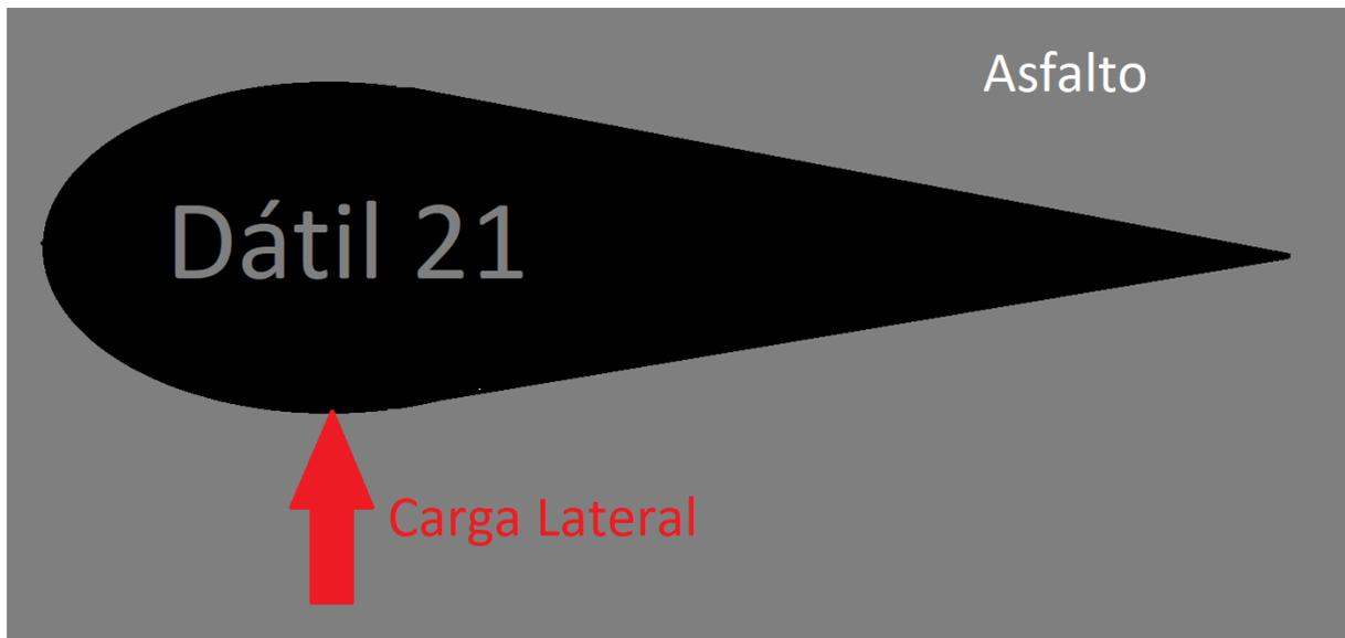
Imagen 13: Representación esquemática de la prueba de cargas laterales (vista de planta), siendo la carga lateral una persona que empuja el coche a la altura del tren delantero, hasta el momento en el que empieza a agotar la adherencia lateral, y derrapa lateralmente.
