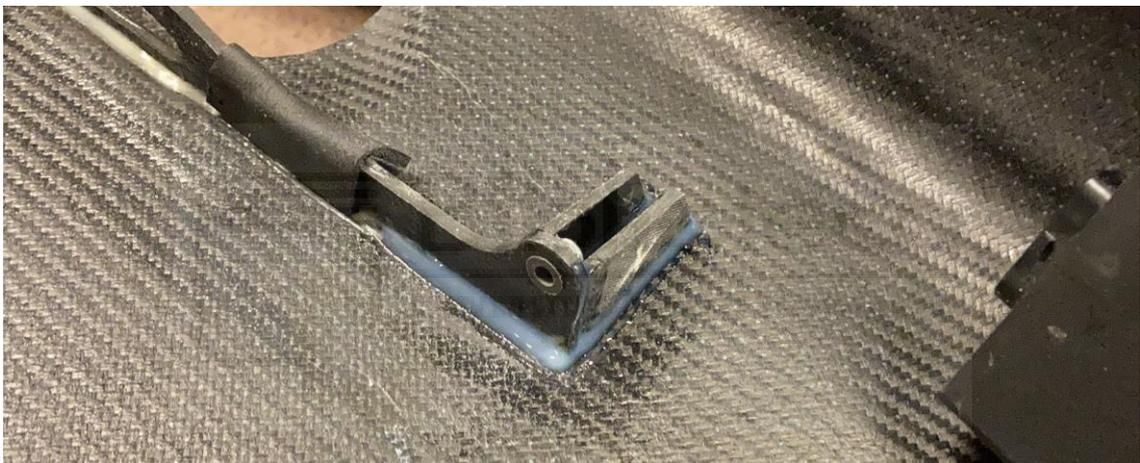
Imagen 31: Detalle del lado izquierdo del vehículo, donde se aprecian los nervios ya instalados, y el adhesivo nuevo.
