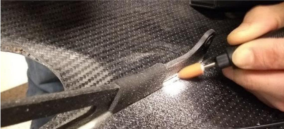
Imagen 30: Detalle del lijado con la Dremel para quitar el adhesivo antiguo
