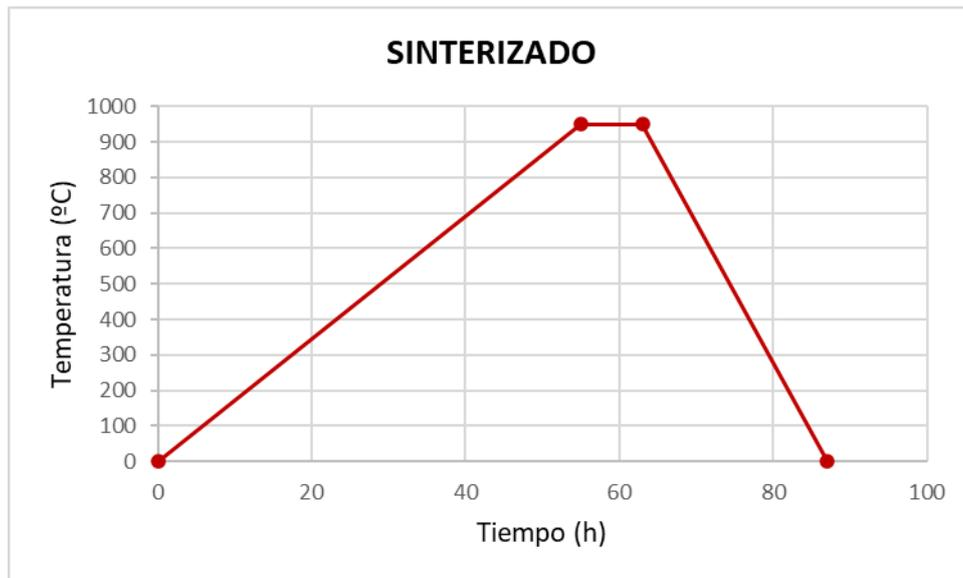
Figura 7: Proceso de sinterizado de la Wollastonita
