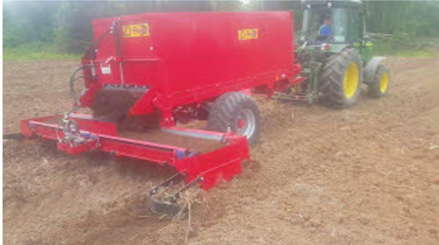
**Fotografía 15:** Aplicación de estiércol a ambos lados de la línea de plantación (elaboración propia).
