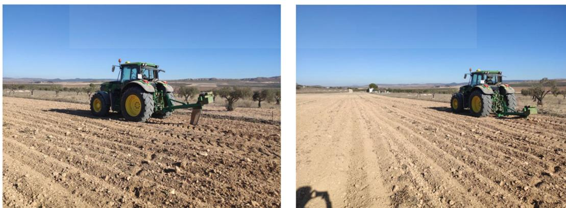
**Fotografías 12 y 13.** Labor de subsolado del terreno (elaboración propia).
