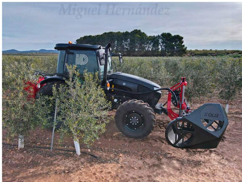
**Fotografía 31:** Máquina podadora de ramas bajas del olivar (elaboración propia).
