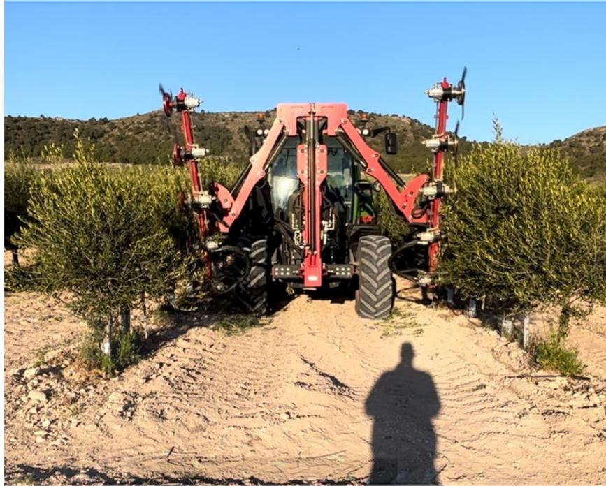
**Fotografía 30:** Máquina podadora de discos para *topping* y poda lateral (elaboración propia).
