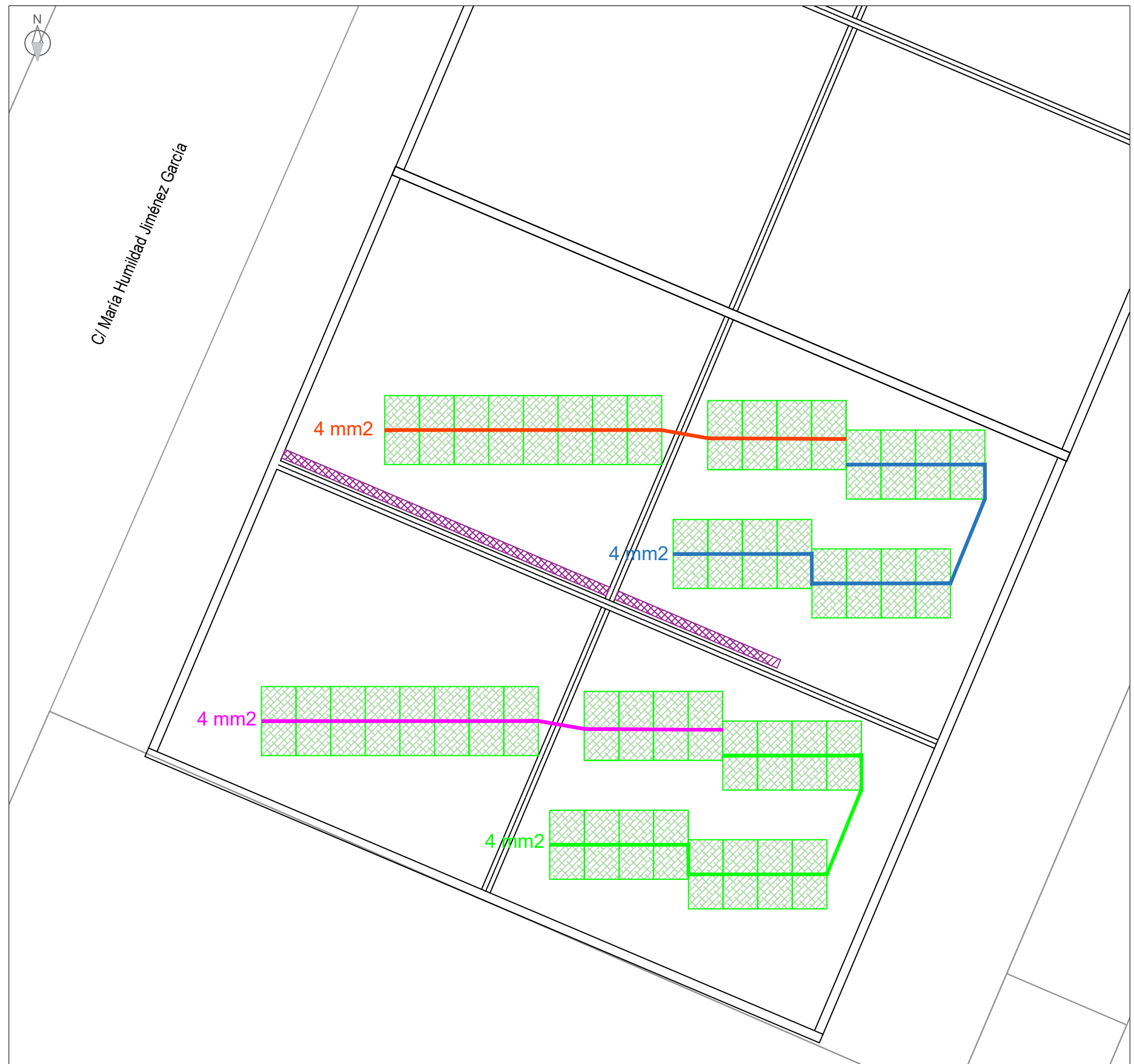
PLANO PLANTA CON DISTRIBUCIÓN STRINGS EN PANELES FOTOVOLTAICOS SOBRE CUBIERTA INCLINADA A DOS AGUAS ESCALA 1/150
