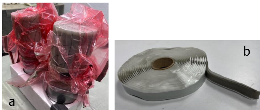
Figura 16. (a) Fabricación de refuerzos empleando bolsa de vacío. (b) Tacky tape
