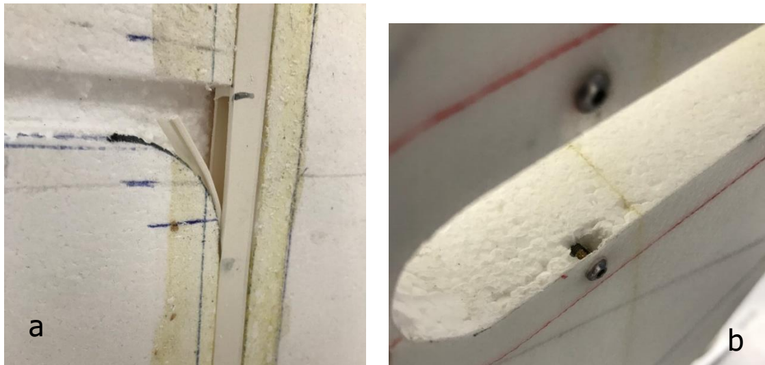
Figura 13. (a) Canal para el cableado. (b) Insertos roscados introducidos en el núcleo.
