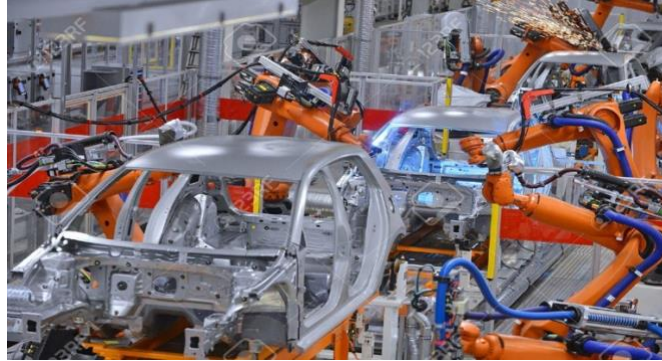
Figura 10. Ejemplo de disposición de robots de soldadura en la industria del automóvil. https://es.123rf.com/photo_16221553_robots-de-soldadura-en-una-f%C3%A1brica-de-autom%C3%B3viles.html
