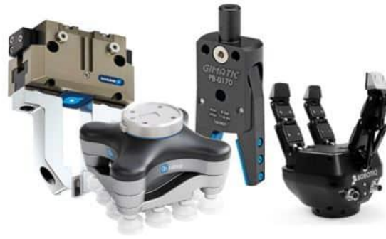
Figura 9. Distintos tipos de grippers utilizados en manipuladores. https://revistaderobots.com/sistemas-de-agarre/tipos-de-gripper-y-pinzas-roboticas/
