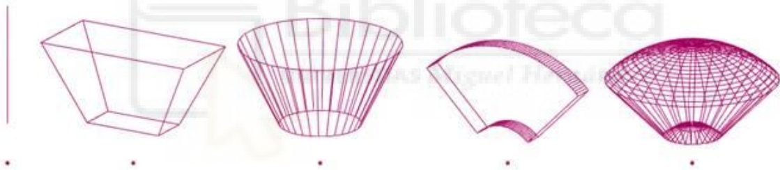
Figura 51. Tipos de sensores de proximidad, de izquierda a derecha: rayo, pirámide, cilindro, disco y cono/rayos aleatorios. https://manual.coppeliarobotics.com/en/proximitySensorDescription.htm
