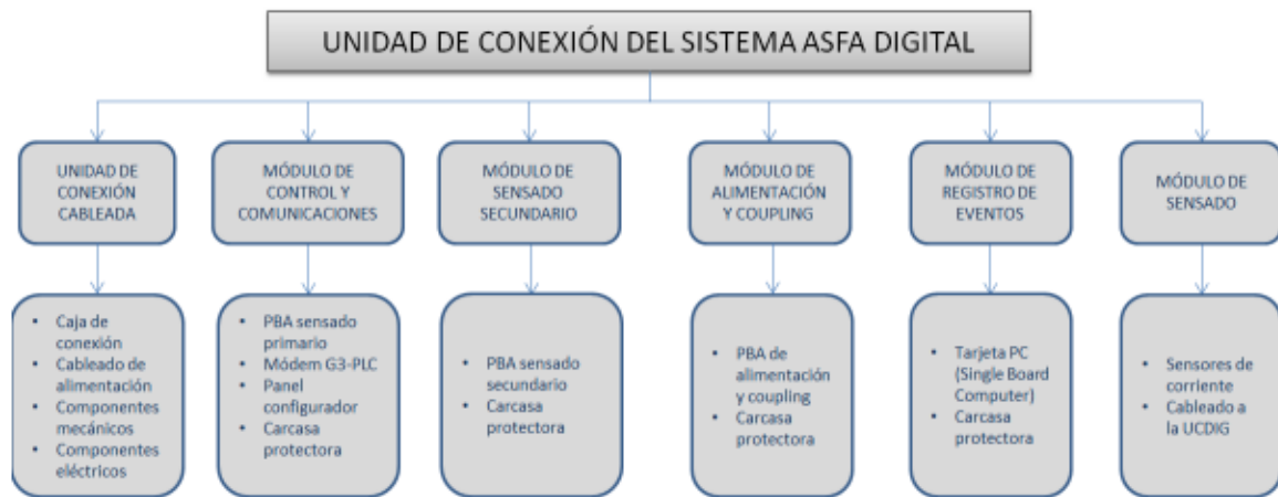
Ilustración 5- Diagrama de bloques de la Unidad de Conexión del Sistema ASFA Digital
