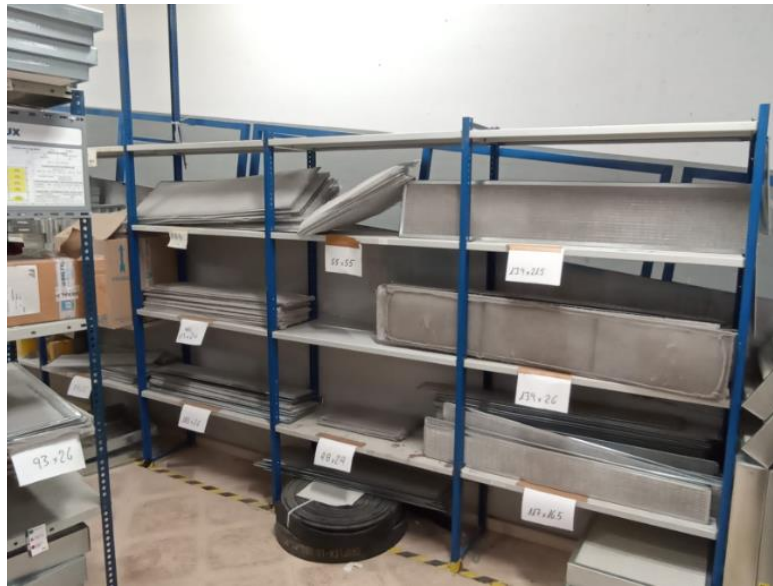
Ilustración 30 Reorganización y etiquetado identificativo de filtros para climatización. Fuente: Elaboración propia
