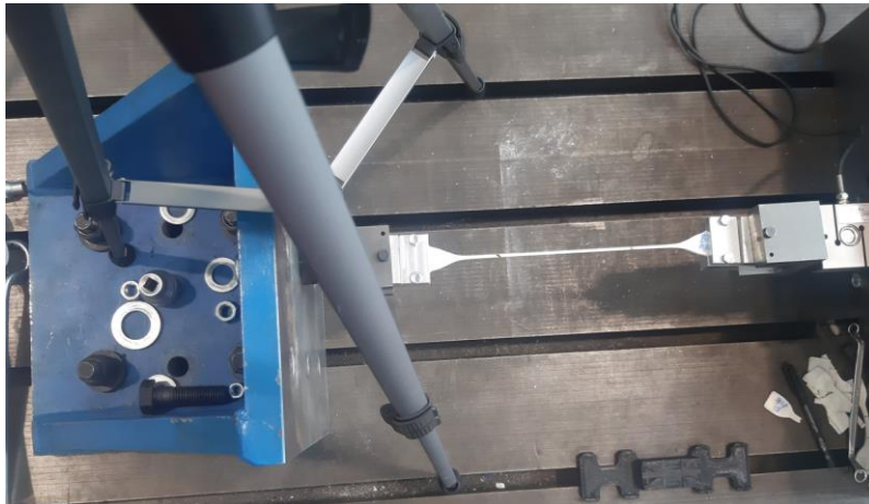
Figura 29. Probeta tipo halterio en su máxima elongación colocada en el banco hidráulico
