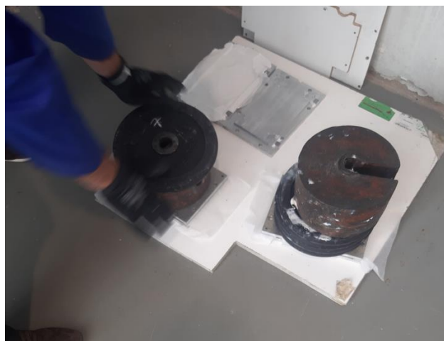
Figura 22. Moldes preparados con pesos sobre ellos
