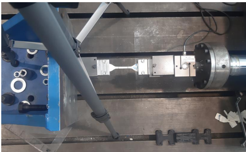
Figura 28. Probeta tipo halterio en reposo colocada en el banco hidráulico
