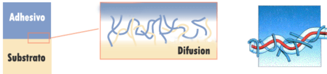
Figura 12. Adhesión por difusión.
