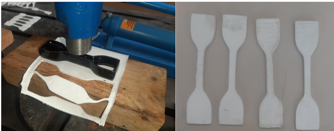
Figura 24. Recortes de la lámina con la cuchilla de forma halterio
