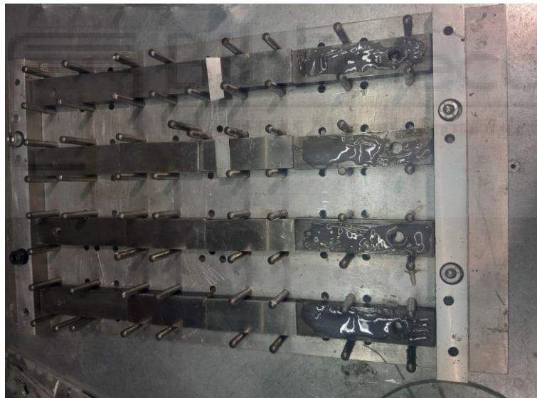
Figura 27. Preparación de adhesión de las pletinas de refuerzo con uniones SLJ
