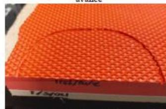
Figura 11: Trayectoria 2, a 18000 rpm y 10 mm/s de avance
