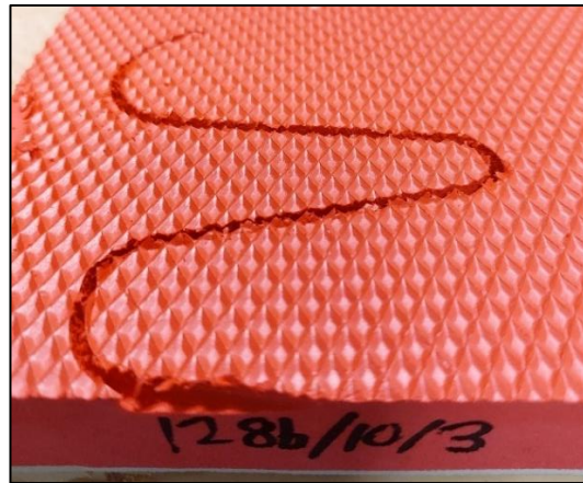
Ilustración 82. Trayectoria 3, prueba realizada a una velocidad de avance de 10 mm/s y 20.000 rpm de giro.
