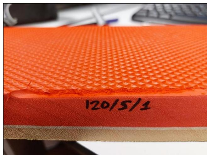
*Ilustración 42: Trayectoria 1. Prueba a 21.000 rpm, velocidad de avance de 5 mm/s*
