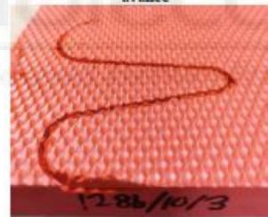
Figura 12: Trayectoria 3, a 18000rpm y 10mm/s de avance
