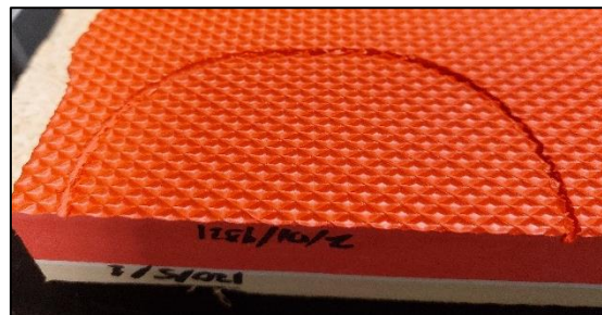
Ilustración 71. Resultados para la trayectoria 2 a 20.000 rpm y 10 mm/s
