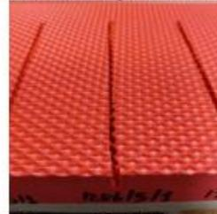
Figura 10: Trayectoria 1, a 18000rpm y 5mm/s de avance
