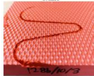
Figura 12: Trayectoria 3, a 18000rpm y 10mm/s de avance
