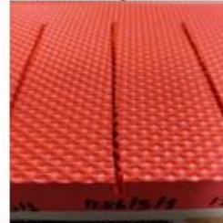
Figura 10: Trayectoria 1, a 18000rpm y 5mm/s de avance
