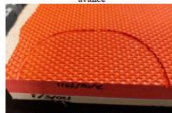
Figura 11: Trayectoria 2, a 18000 rpm y 10 mm/s de avance
