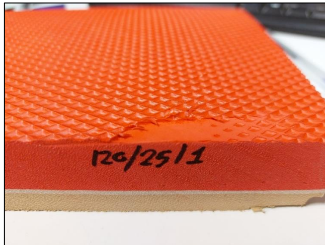
Ilustración 44: Trayectoria 1. Prueba a 21.000 rpm, velocidad de avance de 25 mm/s
