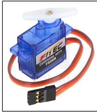
Ilustración 26. Micro servo FS90R. (Robótica Fácil, 2023)
