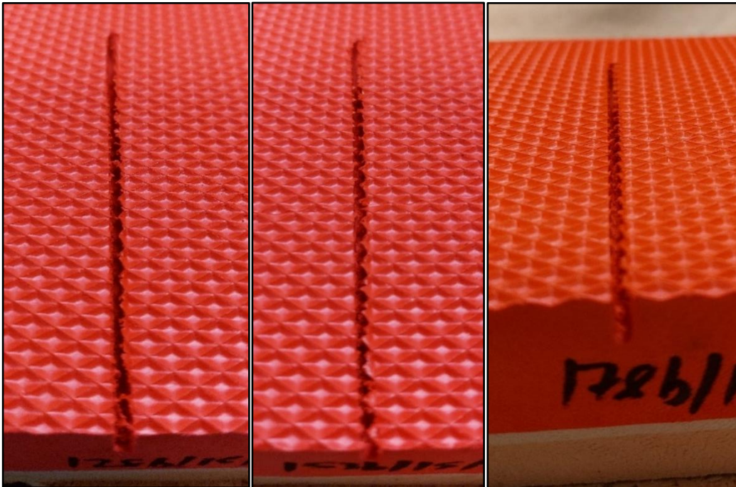
Ilustración 55. Trayectoria 1. Pruebas realizadas a 15 mm/s, velocidades de fresado de 20.000, 17.000 y 14.000 rpm, por orden
