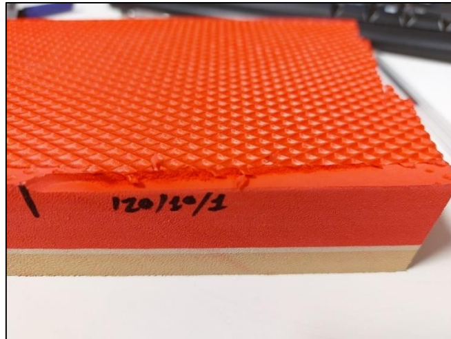
Ilustración 43: Trayectoria 1. Prueba a 21.000 rpm, velocidad de avance de 10 mm/s
