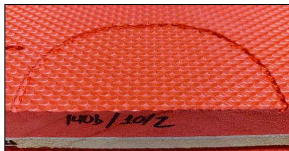
Ilustración 72. Resultados para la trayectoria 2 a 18.500 rpm y 10 mm/s
