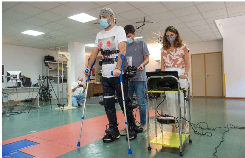
Figura 4. Interfaz cerebro-máquina para control de un exoesqueleto robótico. Figura de Infomedula.
