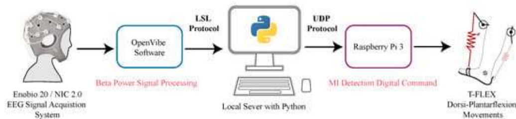
Figura 22. Diagrama de protocolos de comunicación para la integración BCI—T-FLEX a través de un Servidor Local en python.
