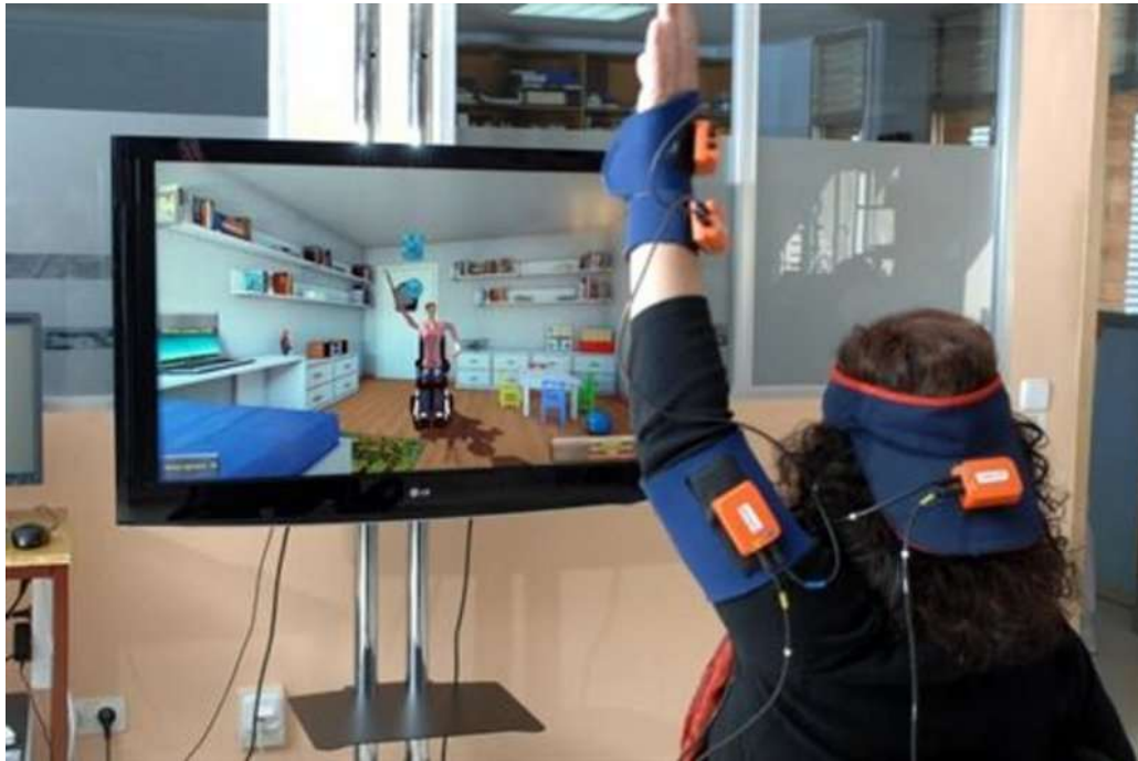
Figura 6. Plataforma de rehabilitación Toyra. La figura muestra el sistema Toyra consistente en una plataforma avanzada de rehabilitación de extremidades superiores que utiliza realidad virtual, captura de movimiento y tecnología de información de atención médica para ofrecer ejercicios interactivos adaptados a pacientes individuales.
