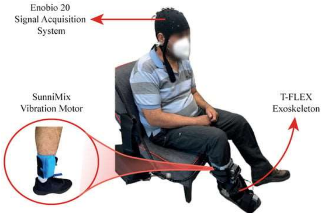
Figura 24. Configuración del sistema experimental para el control basado en BCI utilizando T-FLEX con estímulos visuales y hápticos.
