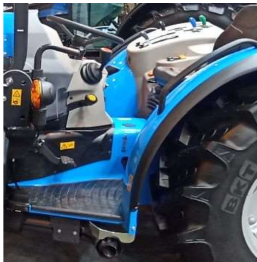
Imagen 12. Estribos de acceso y piso antideslizante. "Fuente propia".
