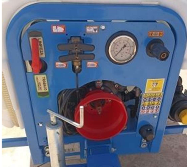
Imagen 32. Manómetro, dispositivos de control, limpieza y vaciado de depósito, "Fuente propia"
