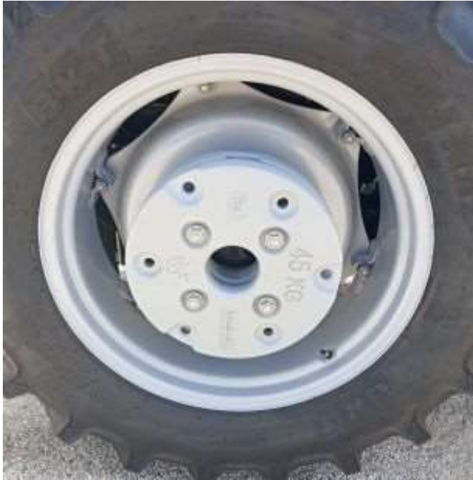
Imagen 18. Lastrado del eje trasero. "Fuente propia".
