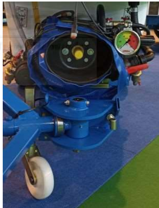
Imagen 28. Protección de la entrada de potencia "Fuente propia"
