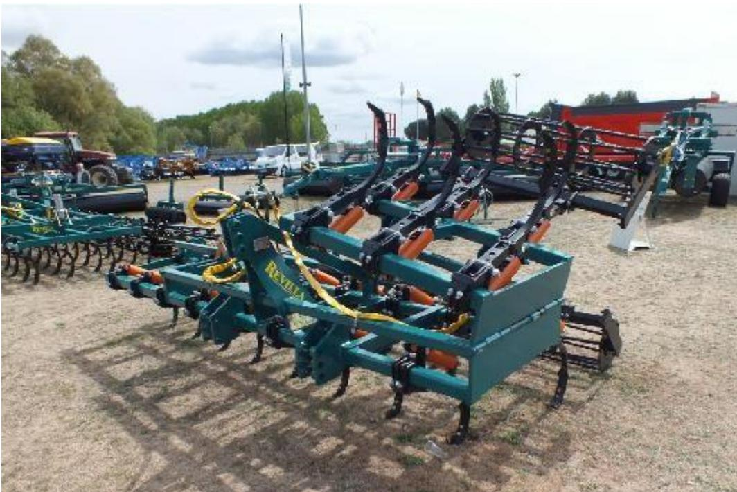
Figura 7. Cultivador Chisel. Imagen. Maquinaria agrícola Revilla 2023.
