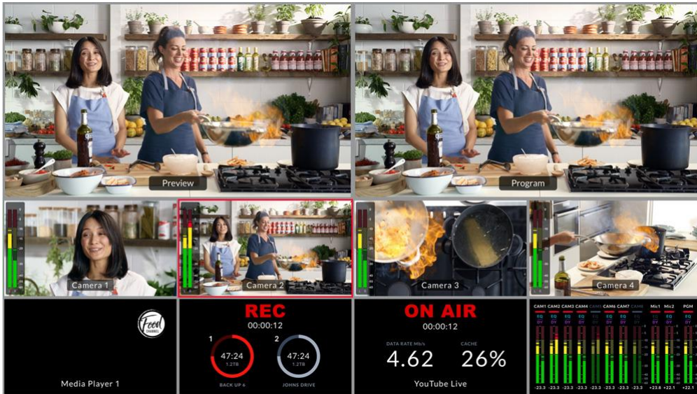
Figura 4: Ejemplo de la función de salida Multipantalla del Blackmagic ATEM Mini Pro
