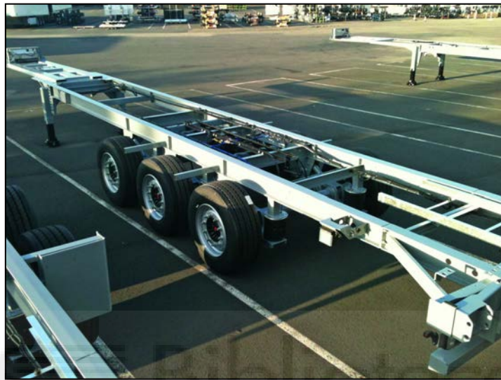
Imagen 4. Estructura chasis de acero Fuente. Internet
