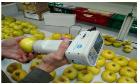
Figura 8: Colorímetro triestímulo Minolta CR- 300
