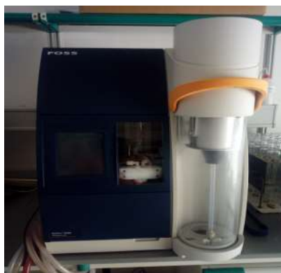
Figura 21. Destilador y valorador de proteína Foss
