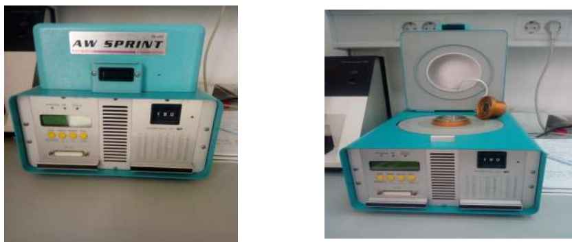
Figura 24. Higrómetro modelo NOVASINA
