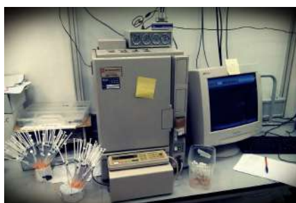
Figura 12: Cromatógrafo de gases Shimadzu GC-14B.
