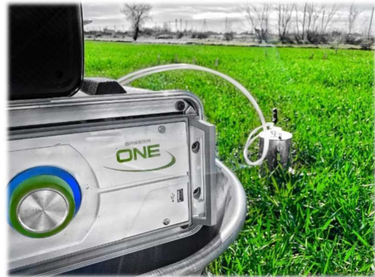
2. Gasera y cámara estática
