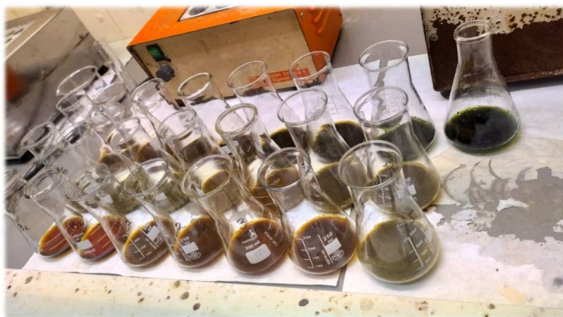
Figura 10. Disoluciones de las muestras de suelo durante la digestión con H_2SO_4
