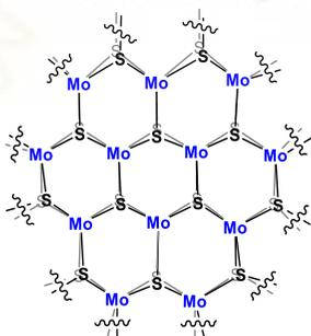
**Figura 4.1:** Estructura prismática trigonal del  $\text{MoS}_2$ .
